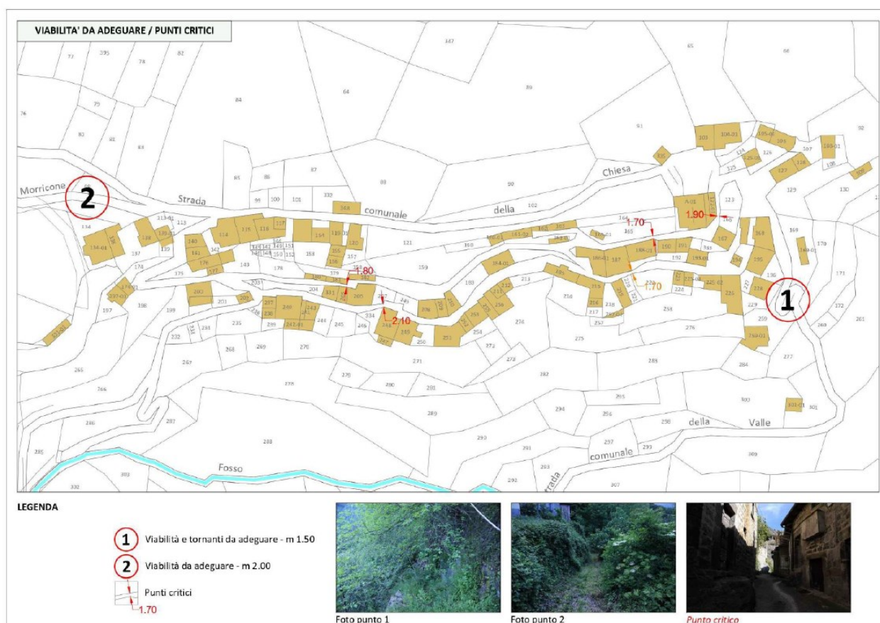
Figura 4 – Illustrazione delle viabilità in ingresso alla frazione da adeguare per la ricostruzione e dei punti critici interni.
