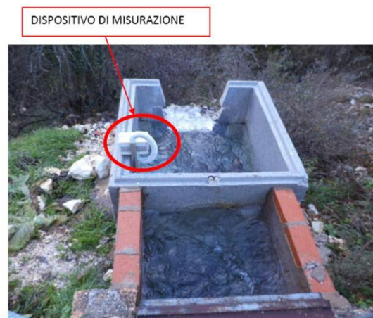
Fig.6.10 – Stramazzo e relativo dispositivo per la misura dei quantitativi "a scarico"
