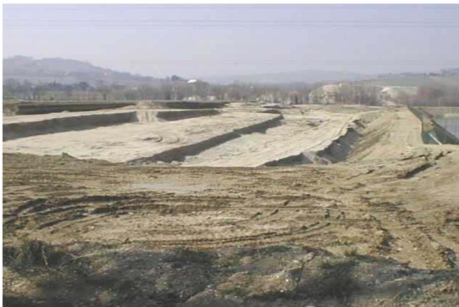
Foto 1 - Cava di pianura per l'estrazione delle ghiaie e sabbie coltivata con il metodo dello splateamento su più gradoni mediante la tecnica dell'abbattimento con mezzi meccanici.
