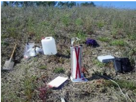
Misura in campo della permeabilità
