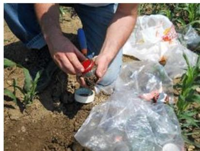
Campionamento con fustelle per la misura della densità apparente e per la definizione della curva di ritenzione idrica
