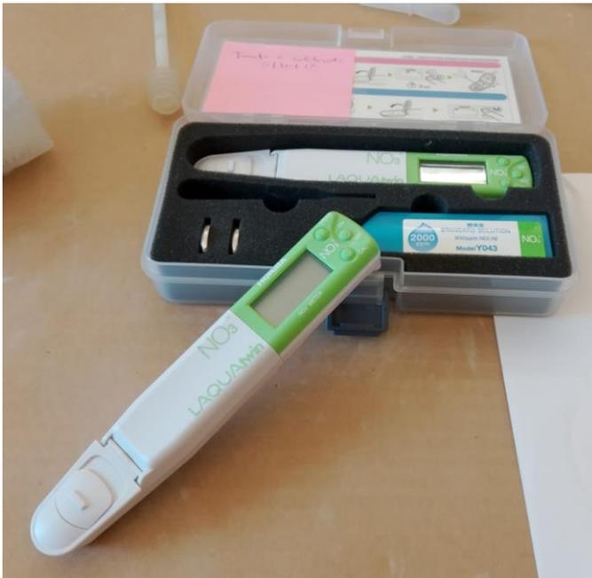
*Strumento di misura LAQUA Twin Nitrate NO3 – Meter, Spectrum Technologies Inc.*
