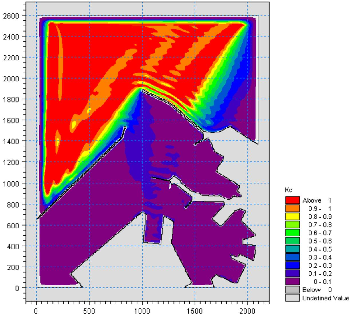
Figura 5.45 – Valori del coefficiente di diffrazione per l'attacco ondoso proveniente da  $10^{\circ}N$  con periodo  $T_p=12s$  nella zona portuale di Ancona per la configurazione con demolizione del Molo Nord (100m) e parziale realizzazione della diga di sottoflutto (assenza tratto terminale inclinato)
