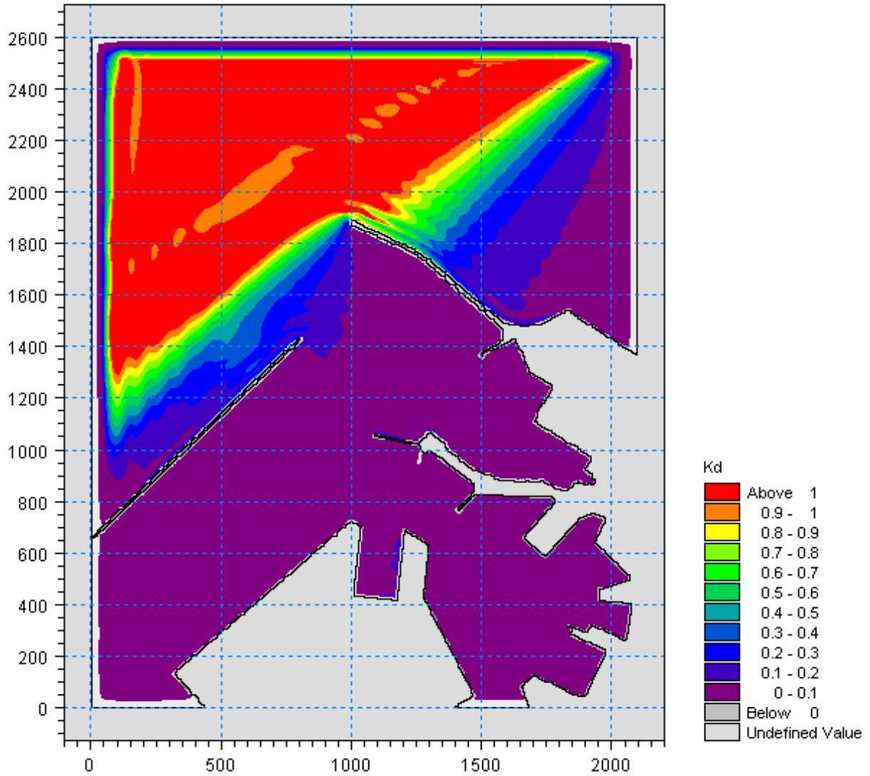
Figura 5.72 – Valori del coefficiente di diffrazione per l'attacco ondoso proveniente da  $30^\circ N$  con periodo  $T_p=12s$  nella zona portuale di Ancona per la configurazione con demolizione del Molo Nord (100m) e parziale realizzazione della diga di sottoflutto (assenza tratto terminale inclinato)
