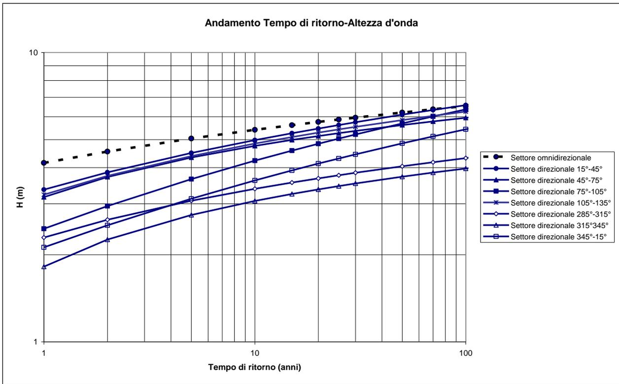
Figura 3.21 - Risultati dell'elaborazione in termini di tempo di ritorno da associare alle mareggiate.
