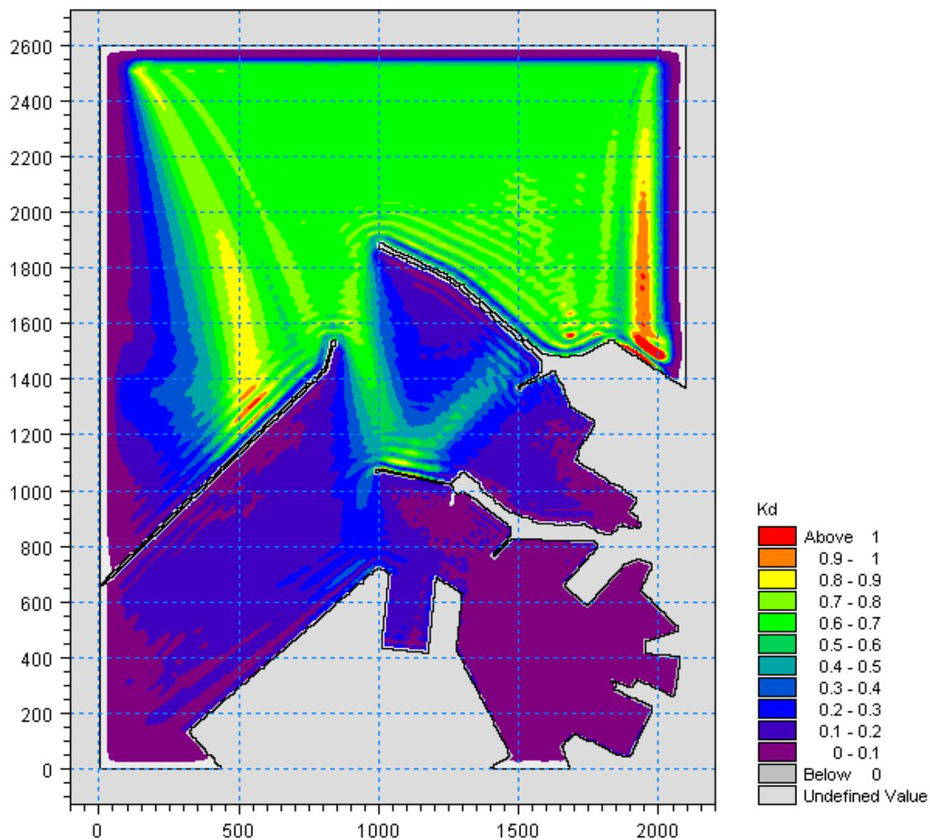
Figura 5.3 - Valori del coefficiente di diffrazione per l'attacco ondoso proveniente da  $330^\circ N$  con periodo  $T_P=7.5s$  nella zona portuale di Ancona per la configurazione attuale del Molo Nord
