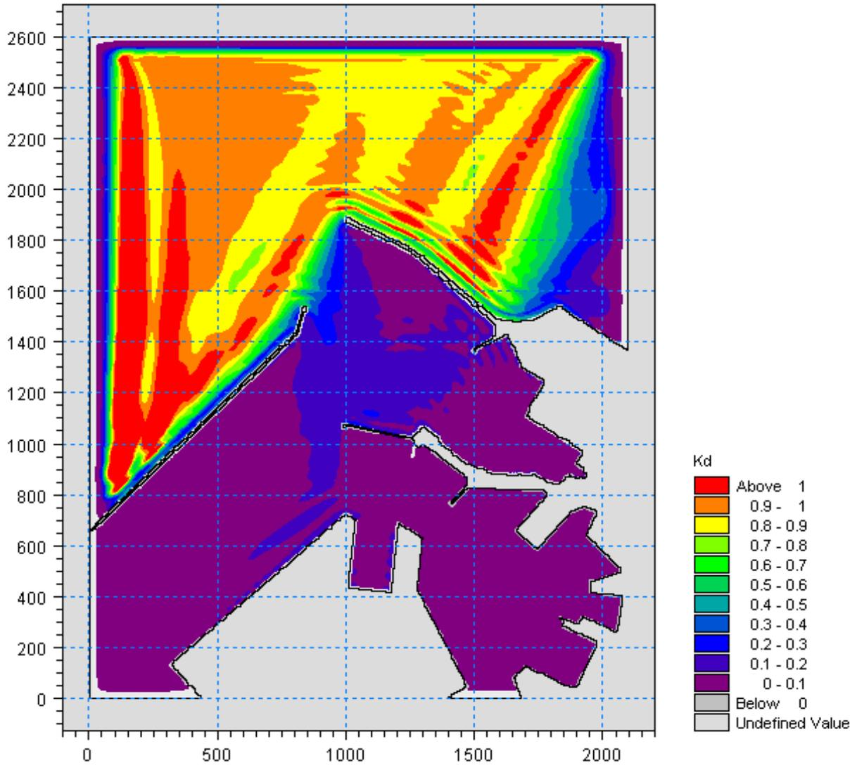
Figura 5.16 – Valori del coefficiente di diffrazione per l'attacco ondoso proveniente da 0°N con periodo  $T_p=10.5s$  nella zona portuale di Ancona per la configurazione attuale del Molo Nord
