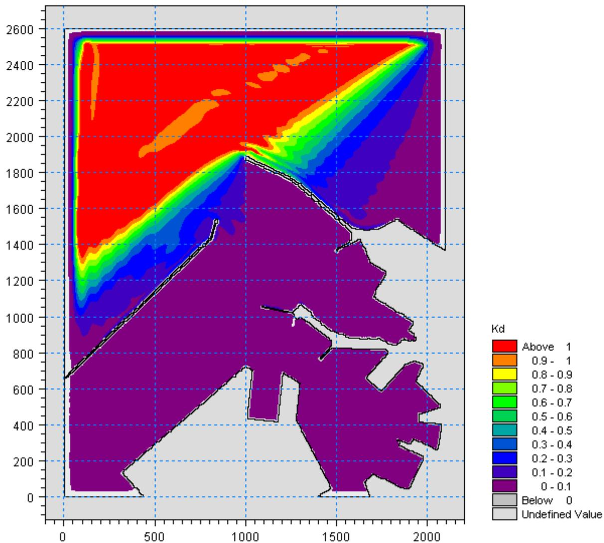
Figura 5.47 – Valori del coefficiente di diffrazione per l'attacco ondoso proveniente da  $30^\circ N$  con periodo  $T_p=12s$  nella zona portuale di Ancona per la configurazione con demolizione del Molo Nord (100m) e parziale realizzazione della diga di sottoflutto (assenza tratto terminale inclinato)
