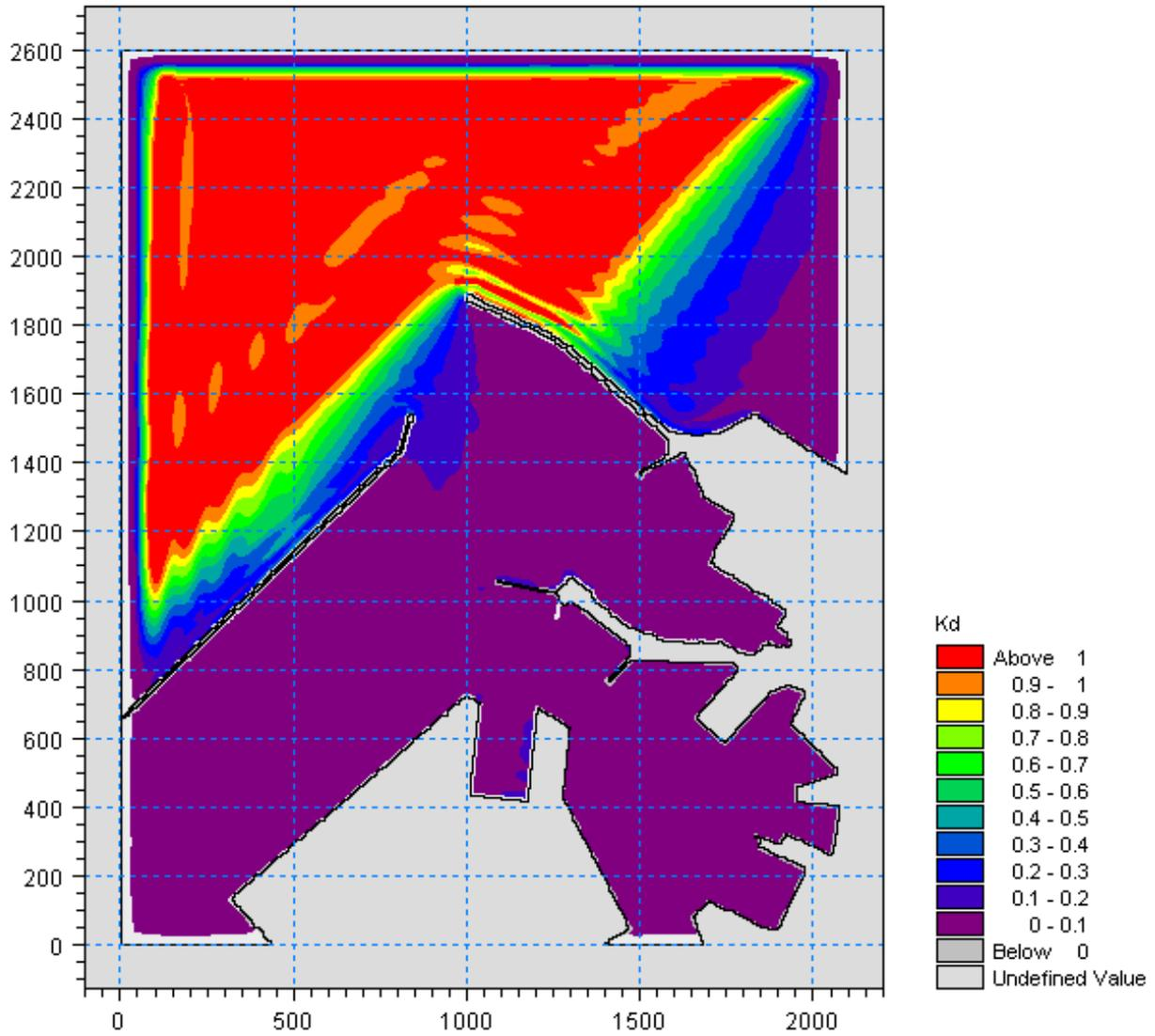
Figura 5.46 – Valori del coefficiente di diffrazione per l'attacco ondoso proveniente da 20°N con periodo  $T_p=12s$  nella zona portuale di Ancona per la configurazione con demolizione del Molo Nord (100m) e parziale realizzazione della diga di sottoflutto (assenza tratto terminale inclinato)
