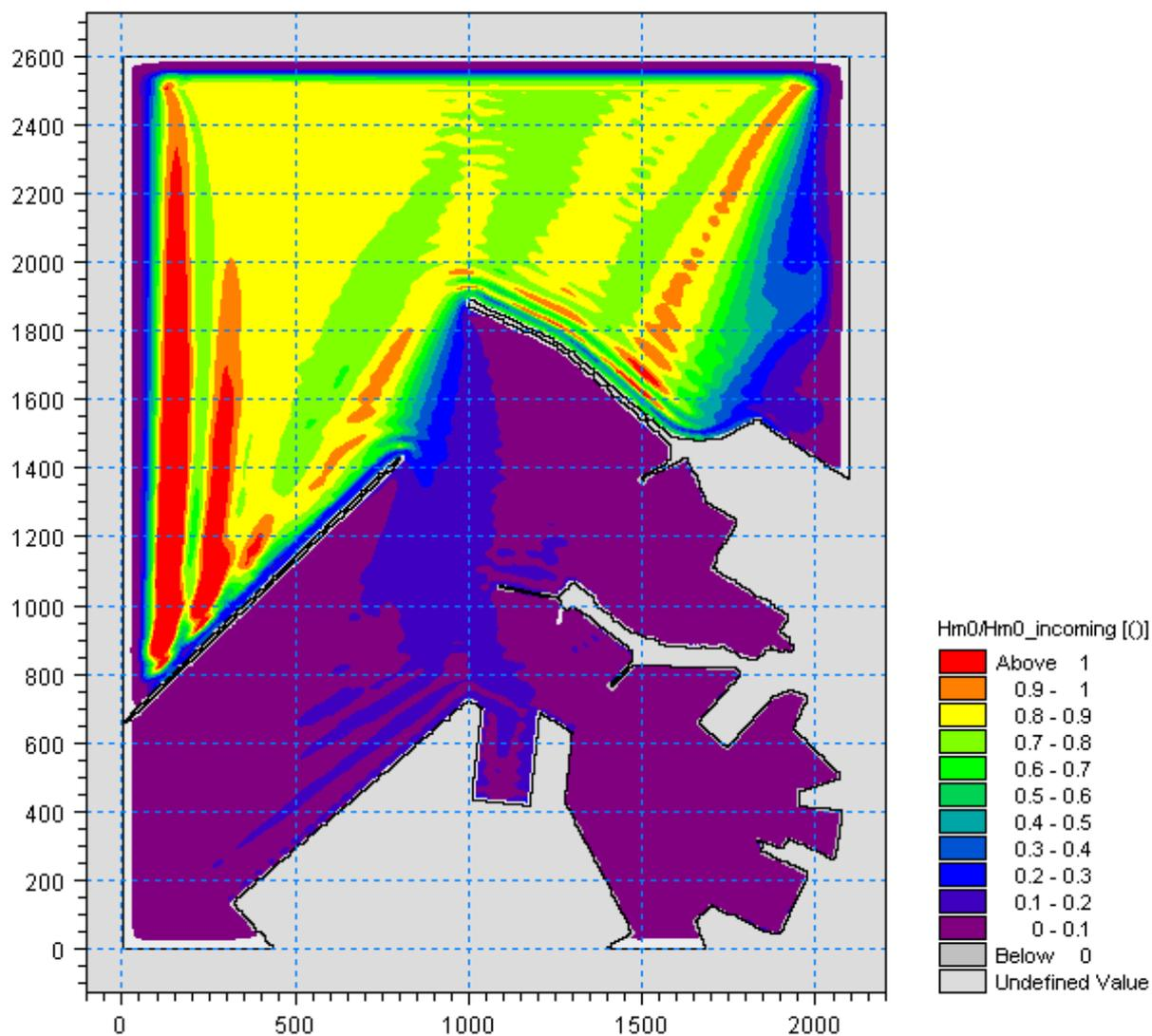
Figura 5.63 – Valori del coefficiente di diffrazione per l'attacco ondoso proveniente da  $0^{\circ}N$  con periodo  $T_p=9s$  nella zona portuale di Ancona per la configurazione con demolizione del Molo Nord (100m) e parziale realizzazione della diga di sottoflutto (assenza tratto terminale inclinato)
