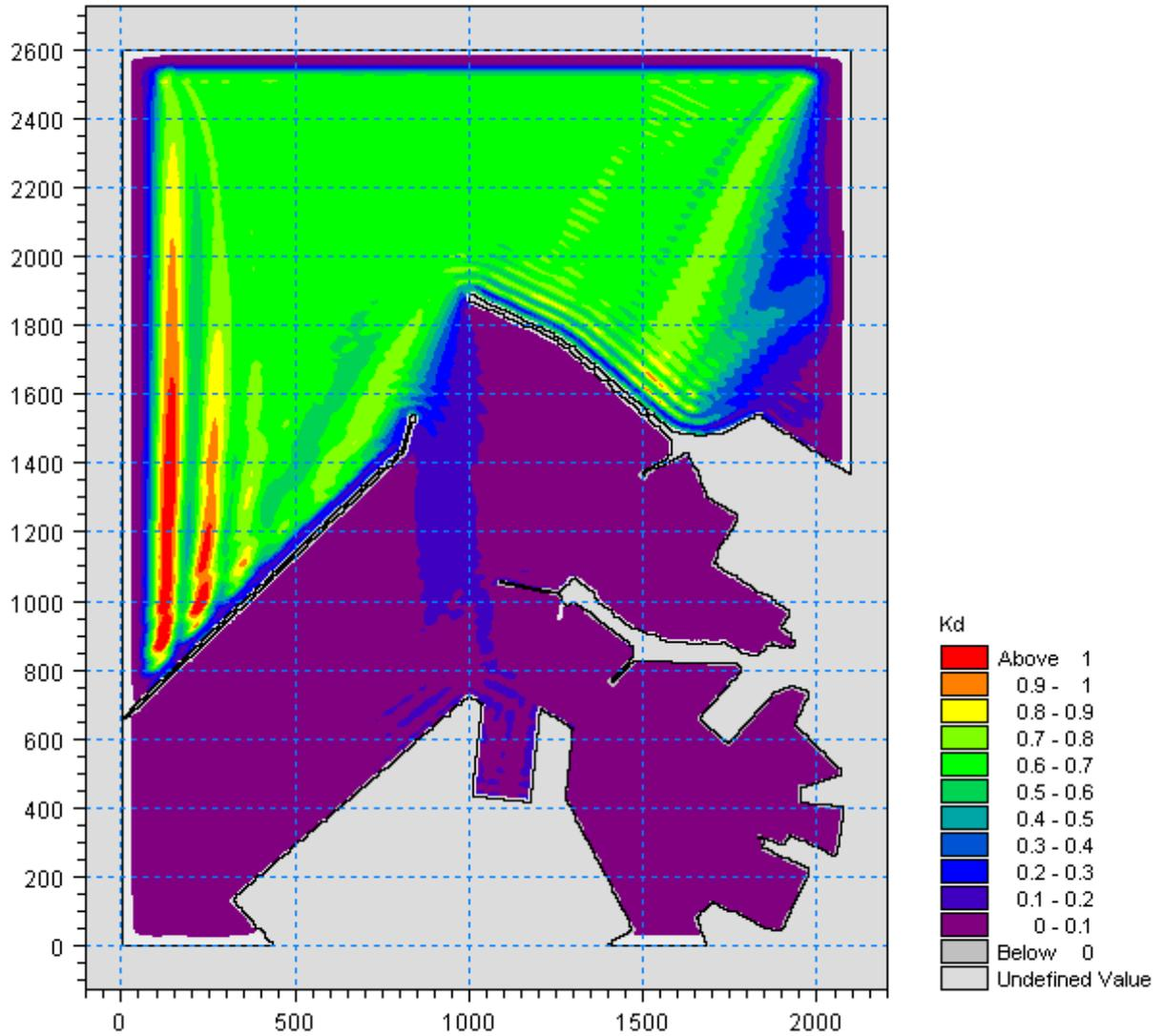
Figura 5.31 – Valori del coefficiente di diffrazione per l'attacco ondoso proveniente da  $0^\circ N$  con periodo  $T_p=7.5s$  nella zona portuale di Ancona per la configurazione con demolizione del Molo Nord (100m) e parziale realizzazione della diga di sottoflutto (assenza tratto terminale inclinato)
