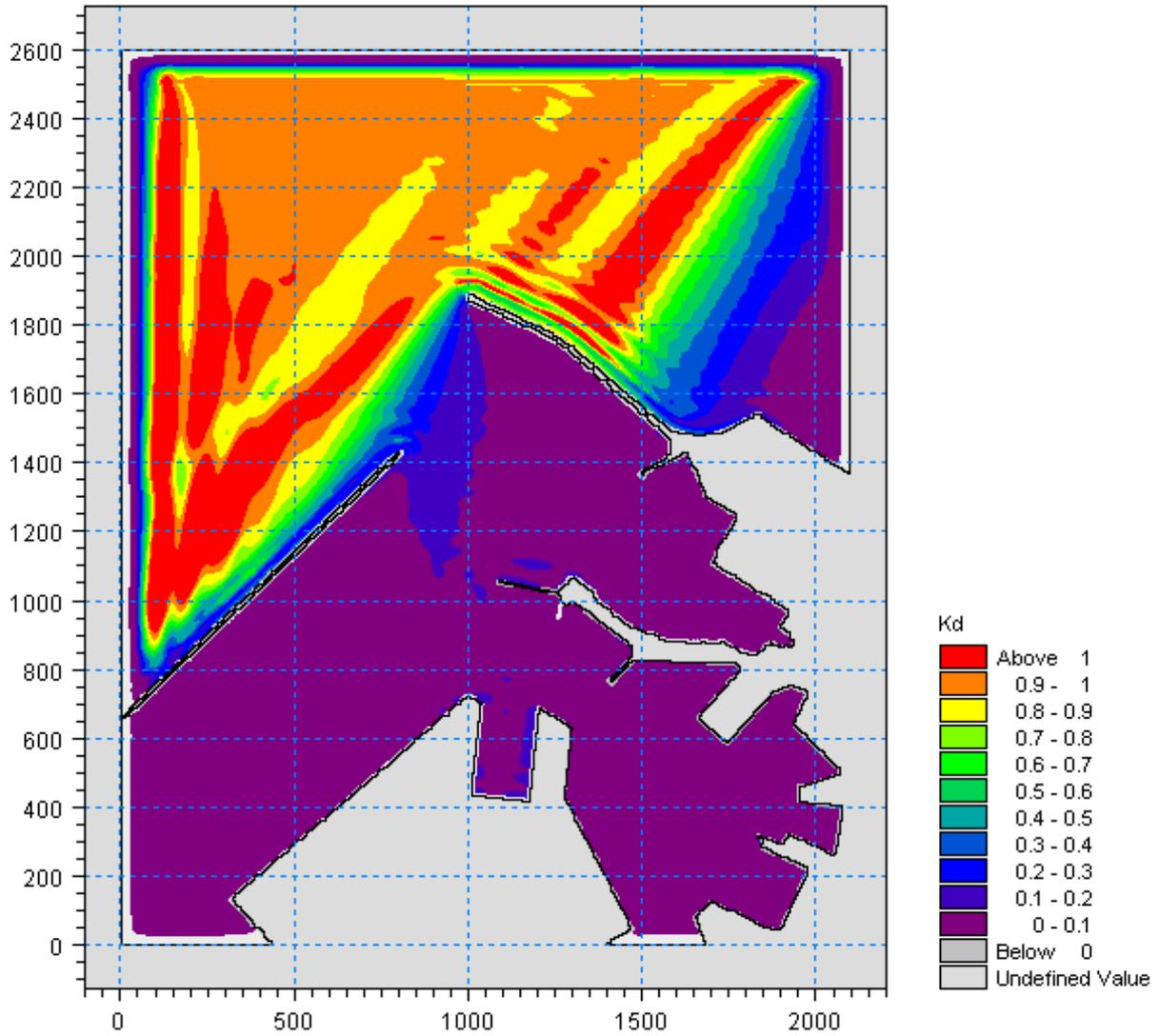
Figura 5.67 – Valori del coefficiente di diffrazione per l'attacco ondoso proveniente da  $10^{\circ}N$  con periodo  $T_p=10.5s$  nella zona portuale di Ancona per la configurazione con demolizione del Molo Nord (100m) e parziale realizzazione della diga di sottoflutto (assenza tratto terminale inclinato)
