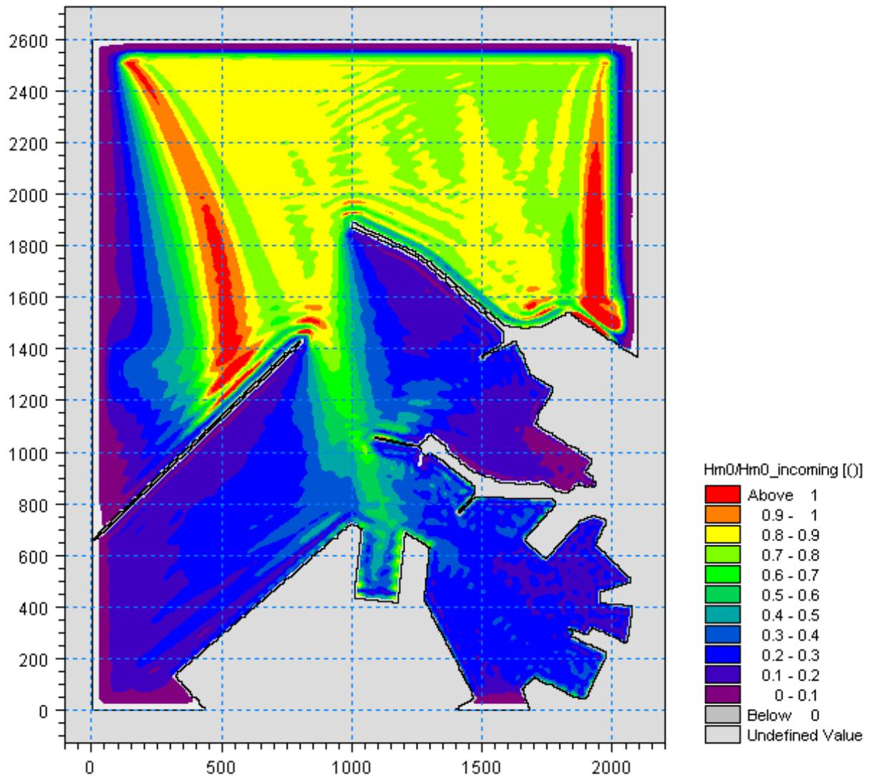
Figura 5.60 – Valori del coefficiente di diffrazione per l'attacco ondoso proveniente da 330°N con periodo  $T_p=9s$  nella zona portuale di Ancona per la configurazione con demolizione del Molo Nord (100m) e parziale realizzazione della diga di sottoflutto (assenza tratto terminale inclinato)
