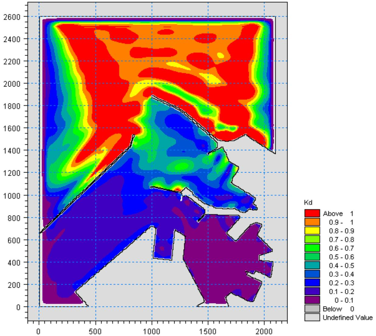
Figura 5.24 – Valori del coefficiente di diffrazione per l'attacco ondoso proveniente da  $330^\circ\text{N}$  con periodo  $T_P=30\text{s}$  nella zona portuale di Ancona per la configurazione attuale del Molo Nord
