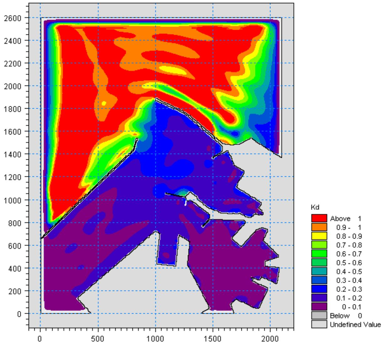
Figura 5.50 – Valori del coefficiente di diffrazione per l'attacco ondoso proveniente da 0°N con periodo  $T_p=30s$  nella zona portuale di Ancona per la configurazione con parziale demolizione (100m) del Molo Nord
