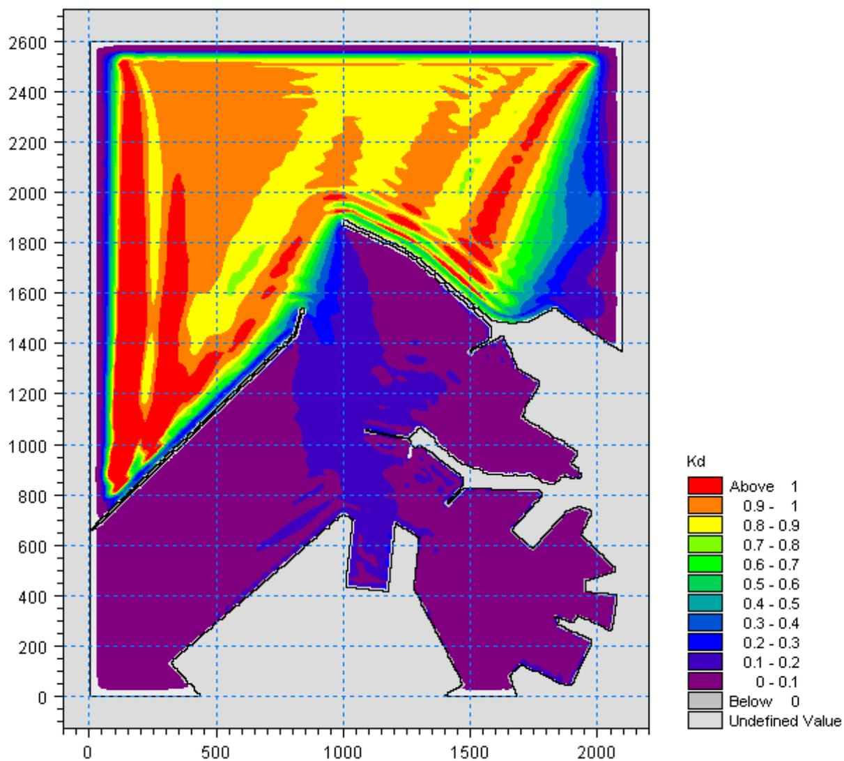
Figura 5.41 – Valori del coefficiente di diffrazione per l'attacco ondoso proveniente da 0°N con periodo  $T_p=10.5s$  nella zona portuale di Ancona per la configurazione con demolizione del Molo Nord (100m) e parziale realizzazione della diga di sottoflutto (assenza tratto terminale inclinato)
