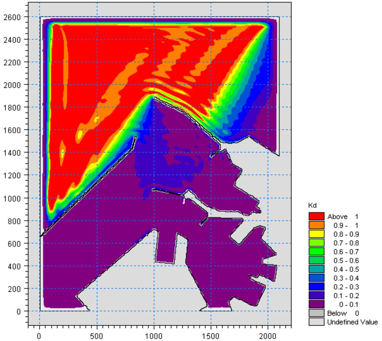
Figura 5.20 – Valori del coefficiente di diffrazione per l'attacco ondoso proveniente da  $10^\circ N$  con periodo  $T_P=12s$  nella zona portuale di Ancona per la configurazione attuale del Molo Nord
