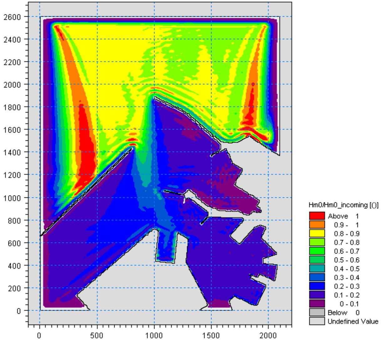
Figura 5.61 – Valori del coefficiente di diffrazione per l'attacco ondoso proveniente da 340°N con periodo  $T_p=9s$  nella zona portuale di Ancona per la configurazione con demolizione del Molo Nord (100m) e parziale realizzazione della diga di sottoflutto (assenza tratto terminale inclinato)
