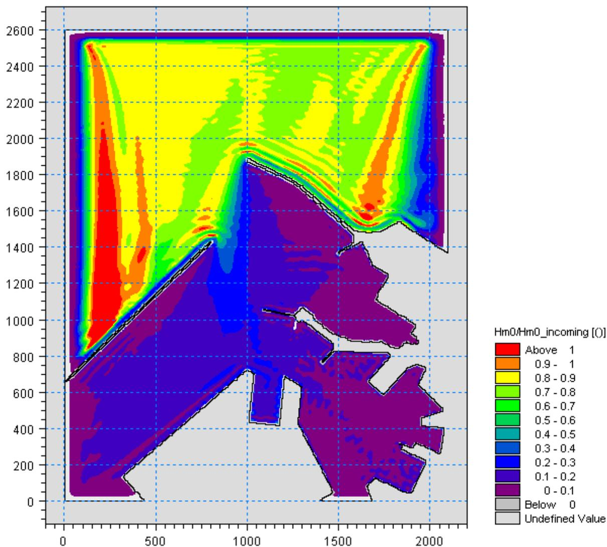
Figura 5.62 – Valori del coefficiente di diffrazione per l'attacco ondoso proveniente da 350°N con periodo  $T_p=9s$  nella zona portuale di Ancona per la configurazione con demolizione del Molo Nord (100m) e parziale realizzazione della diga di sottoflutto (assenza tratto terminale inclinato)
