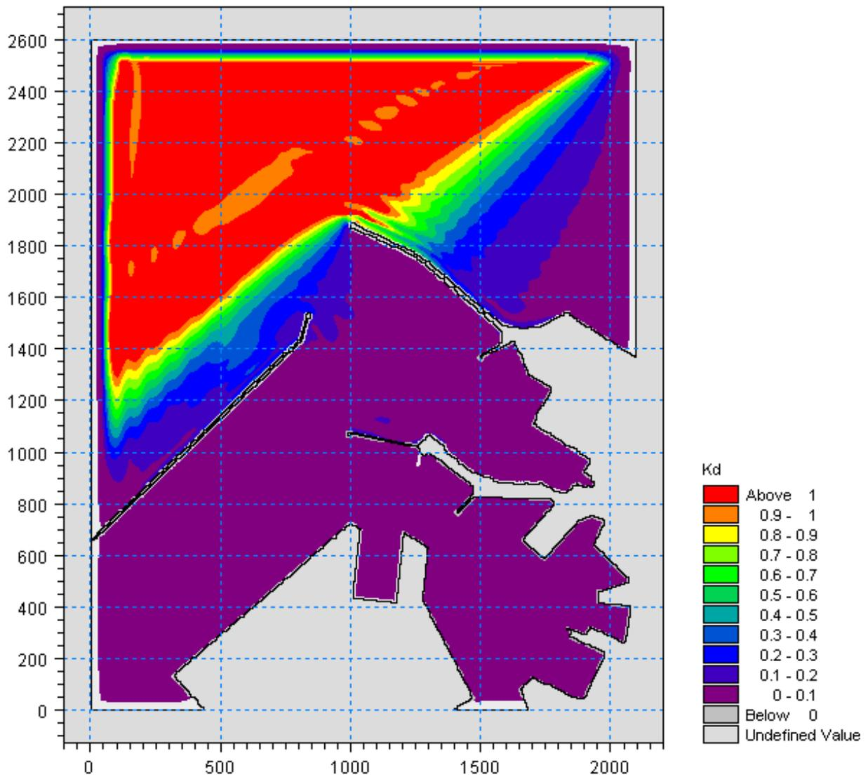
Figura 5.22 – Valori del coefficiente di diffrazione per l'attacco ondoso proveniente da  $30^\circ N$  con periodo  $T_p=12s$  nella zona portuale di Ancona per la configurazione attuale del Molo Nord
