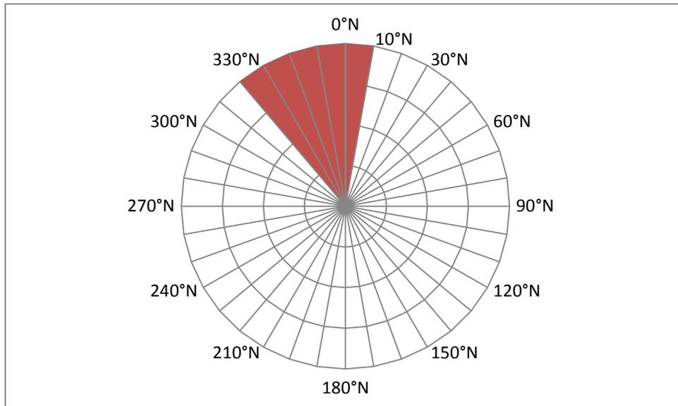
Figura 5.26 – Schema con le direzioni ondose di provenienza considerate ( $320^\circ N - 330^\circ N - 340^\circ N - 350^\circ N - 0^\circ N - 10^\circ N$ ) per il periodo di picco  $T_p=7.5s$
