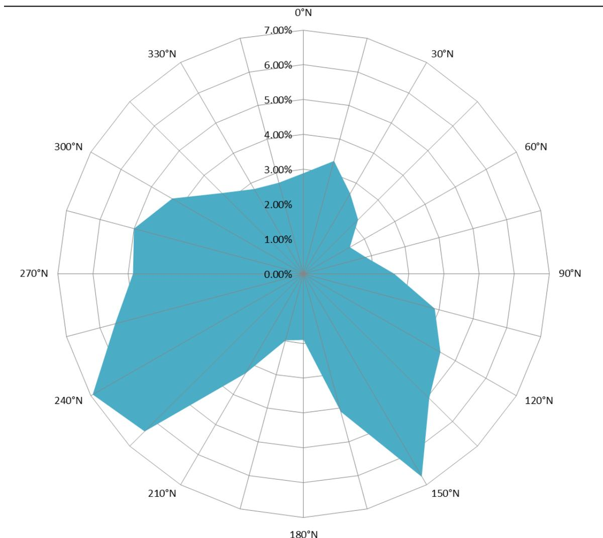
*Figura 3.22 - Distribuzione direzionale della frequenza percentuale dei dati anemometrici registrati dalla stazione di misura della RMN al porto turistico di Ancona nei 13 anni del periodo di osservazione dal 2001 al 2013*
