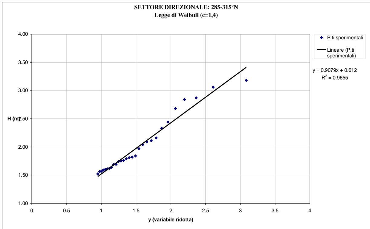
Figura 3.17 - Dati sperimentali e legge probabilistica di miglior adattamento per il settore direzionale 285°N-315°N
