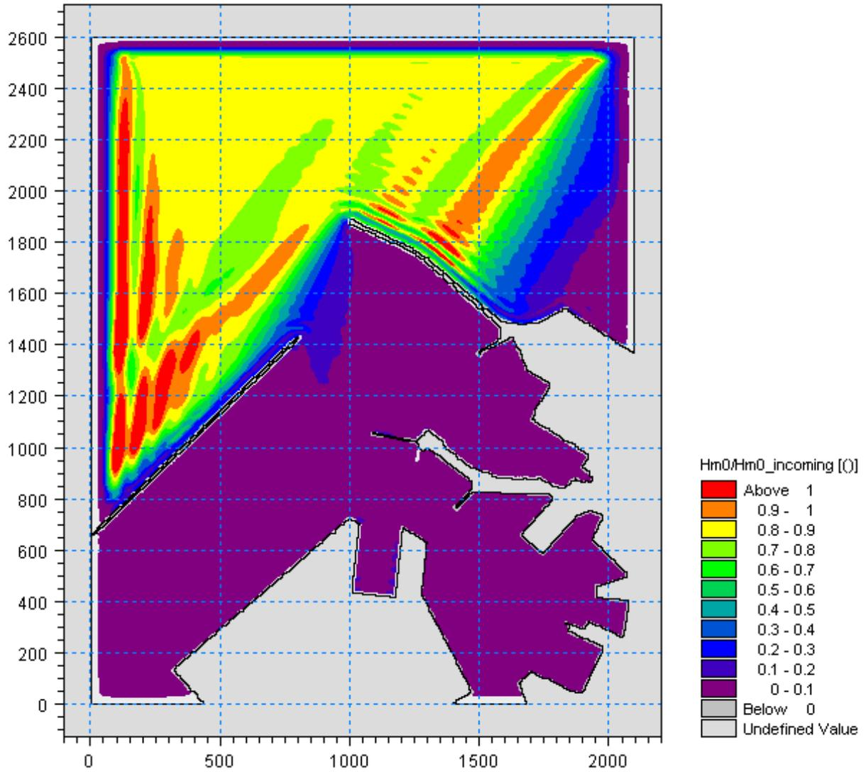
Figura 5.64 – Valori del coefficiente di diffrazione per l'attacco ondoso proveniente da 10°N con periodo  $T_p=9s$  nella zona portuale di Ancona per la configurazione con demolizione del Molo Nord (100m) e parziale realizzazione della diga di sottoflutto (assenza tratto terminale inclinato)
