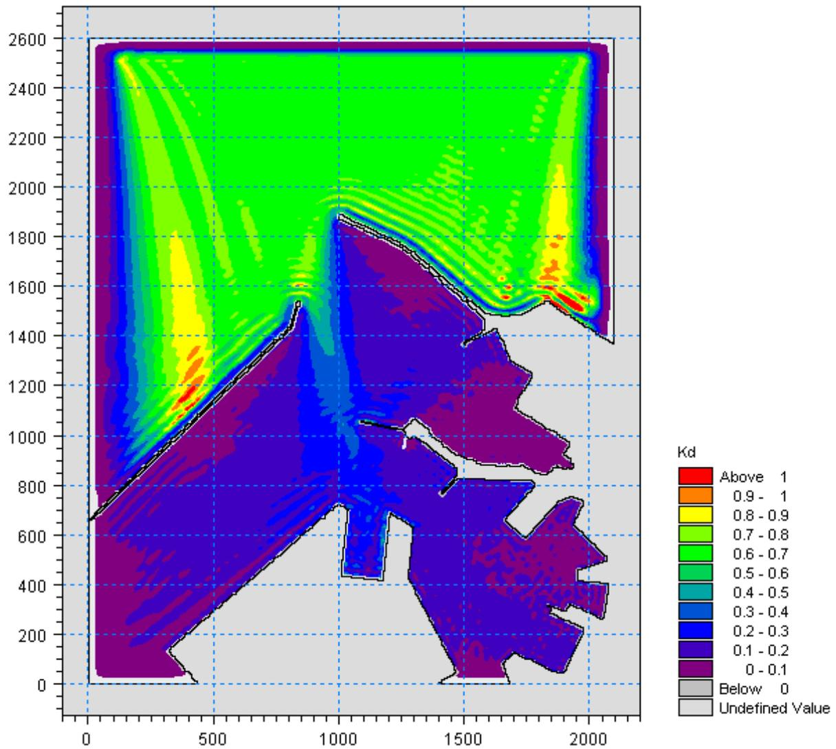
Figura 5.29 – Valori del coefficiente di diffrazione per l'attacco ondoso proveniente da 340°N con periodo  $T_p=7.5s$  nella zona portuale di Ancona per la configurazione con parziale demolizione (100m) del Molo Nord
