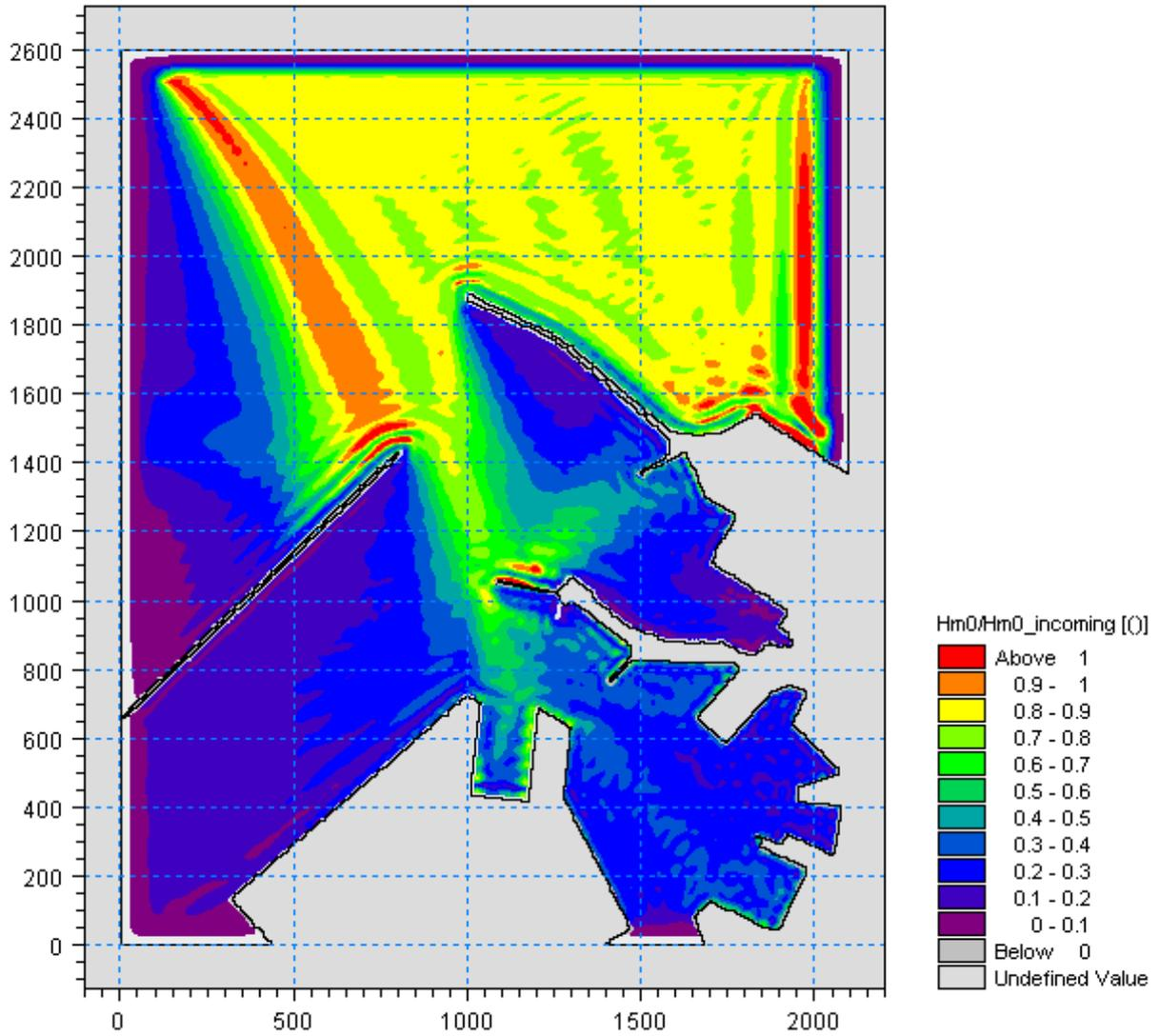
Figura 5.59 – Valori del coefficiente di diffrazione per l'attacco ondoso proveniente da 320°N con periodo  $T_P=9s$  nella zona portuale di Ancona per la configurazione con demolizione del Molo Nord (100m) e parziale realizzazione della diga di sottoflutto (assenza tratto terminale inclinato)
