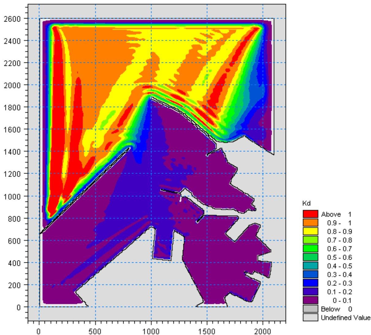
Figura 5.66 – Valori del coefficiente di diffrazione per l'attacco ondoso proveniente da  $0^\circ N$  con periodo  $T_p=10.5s$  nella zona portuale di Ancona per la configurazione con demolizione del Molo Nord (100m) e parziale realizzazione della diga di sottoflutto (assenza tratto terminale inclinato)
