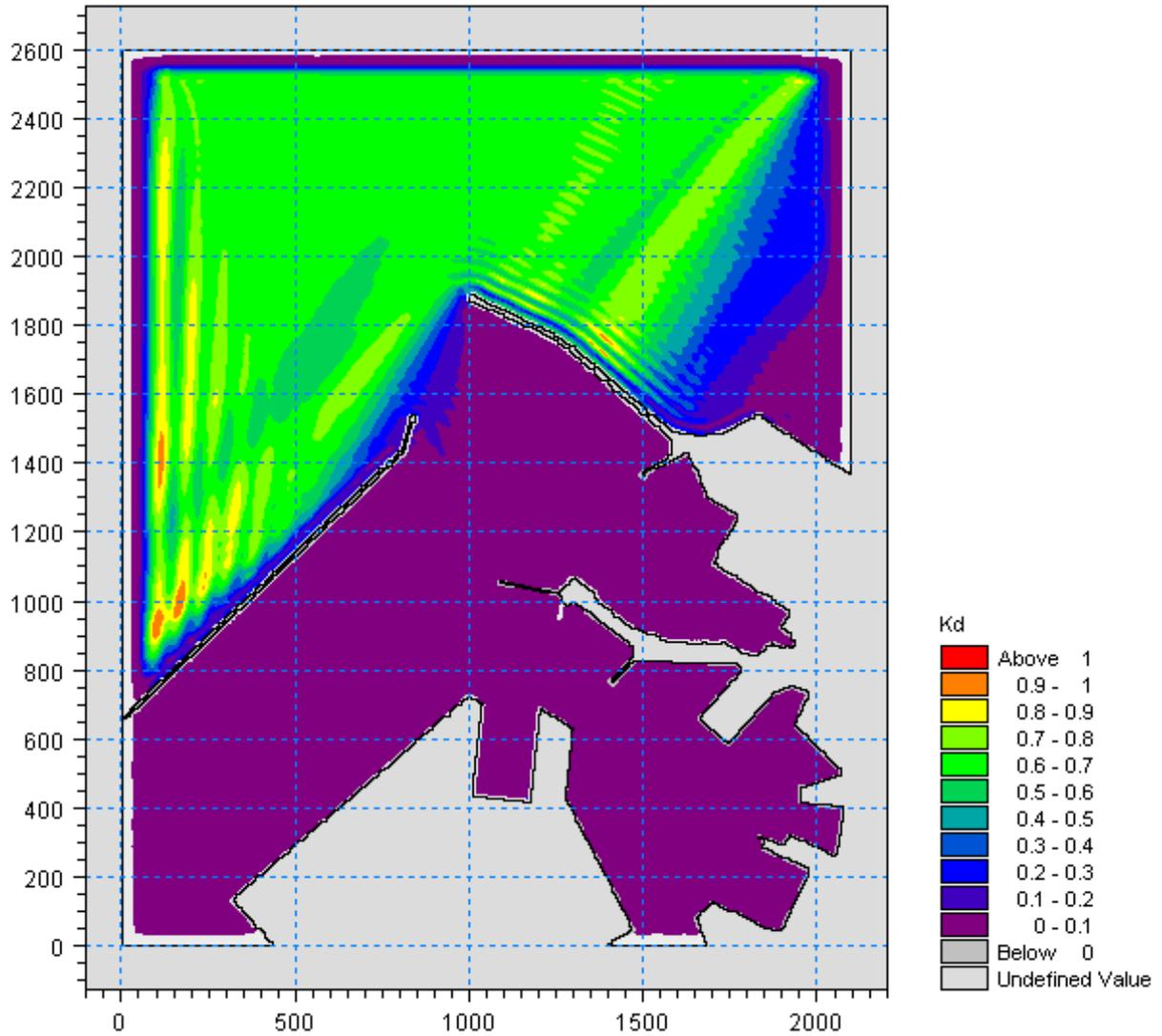
Figura 5.32 – Valori del coefficiente di diffrazione per l'attacco ondoso proveniente da  $10^\circ N$  con periodo  $T_p=7.5s$  nella zona portuale di Ancona per la configurazione con parziale demolizione (100m) del Molo Nord
