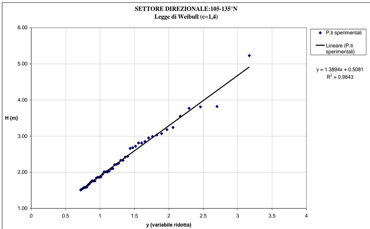
*Figura 3.16 - Dati sperimentali e legge probabilistica di miglior adattamento per il settore direzionale 105°N-135°N*
