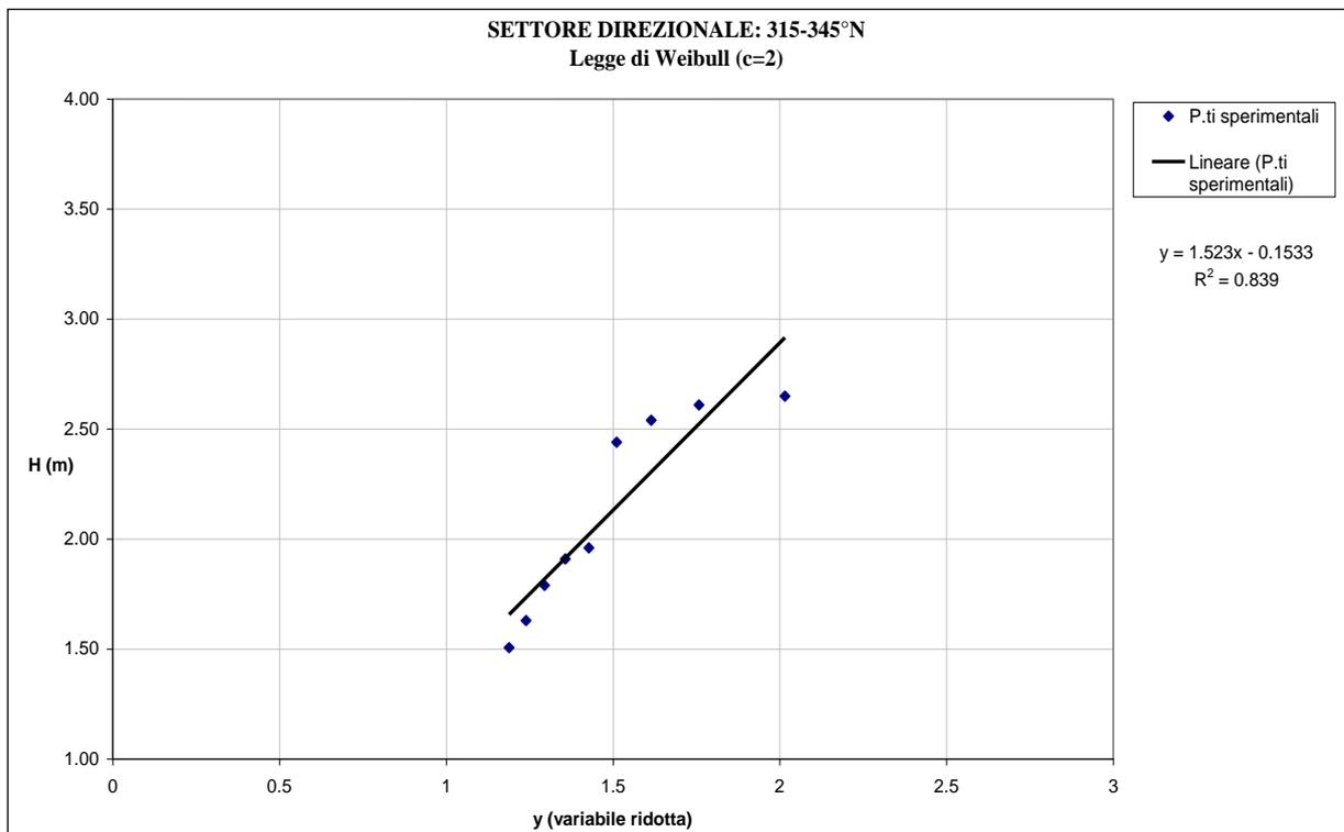
Figura 3.18 - Dati sperimentali e legge probabilistica di miglior adattamento per il settore direzionale 315°N-345°N
