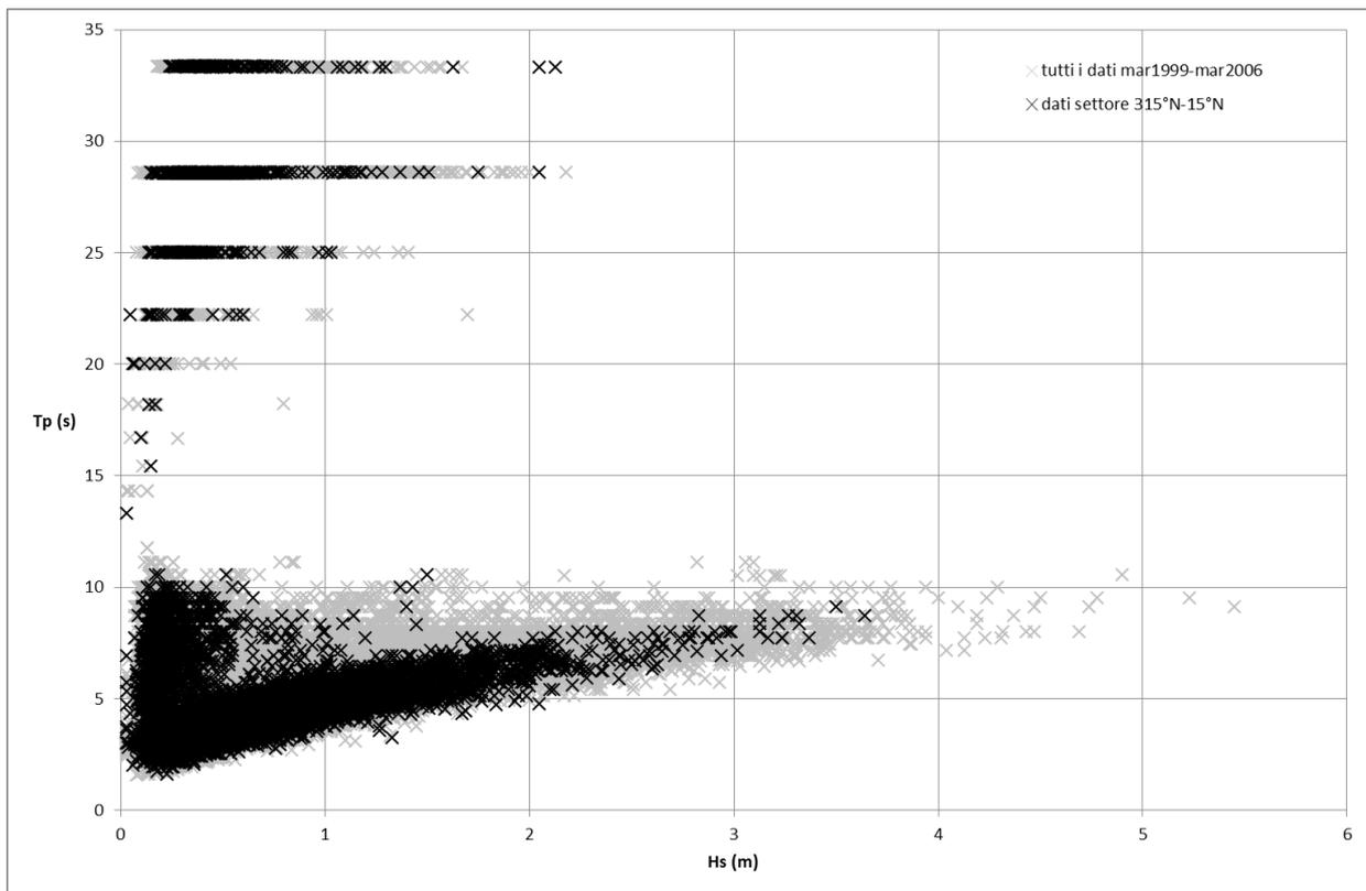
Figura 4.12– Periodi ondosi di picco rispetto all'altezza significativa per i dati della boa ondometrica della RON al largo di Ancona con evidenziati quelli del settore 315°N-15°N
