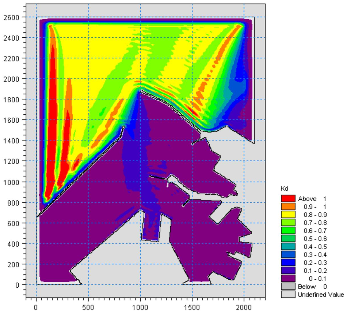
Figura 5.38 – Valori del coefficiente di diffrazione per l'attacco ondoso proveniente da  $0^\circ N$  con periodo  $T_p=9s$  nella zona portuale di Ancona per la configurazione con demolizione del Molo Nord (100m) e parziale realizzazione della diga di sottoflutto (assenza tratto terminale inclinato)
