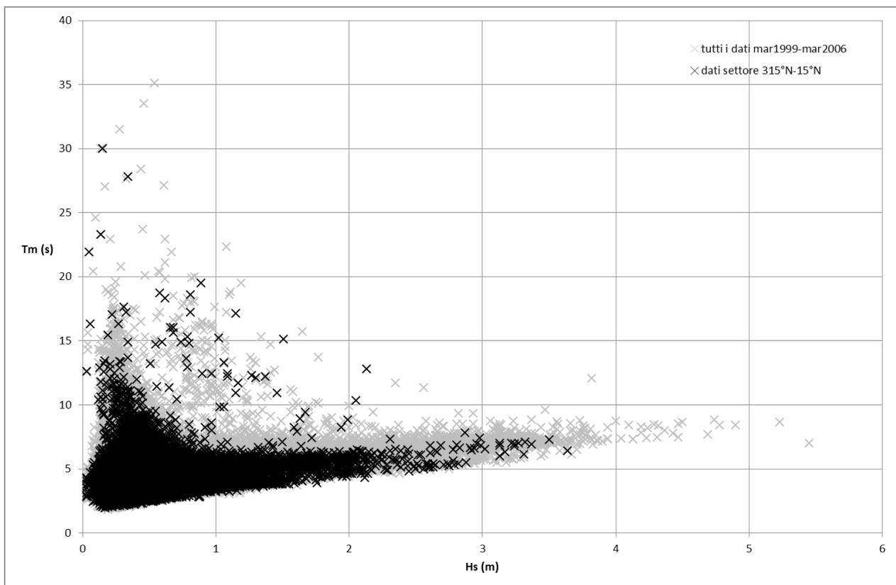
Figura 4.13 – Periodi ondosi medi rispetto all'altezza significativa per i dati della boa ondometrica della RON al largo di Ancona con evidenziati quelli del settore 315°N-15°N
