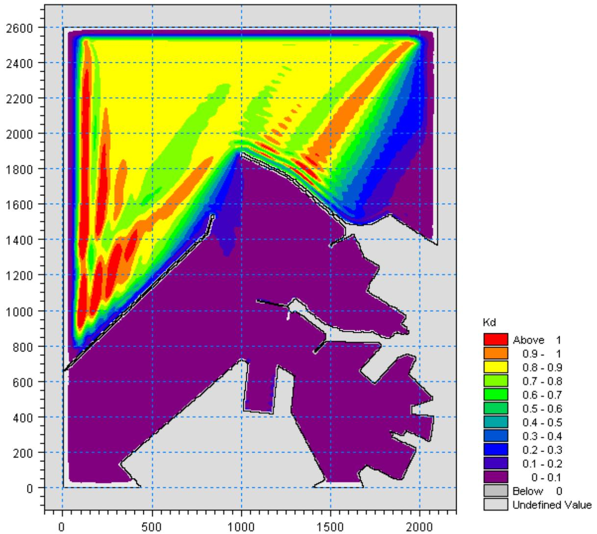
Figura 5.39 – Valori del coefficiente di diffrazione per l'attacco ondoso proveniente da  $10^\circ N$  con periodo  $T_p=9s$  nella zona portuale di Ancona per la configurazione con demolizione del Molo Nord (100m) e parziale realizzazione della diga di sottoflutto (assenza tratto terminale inclinato)
