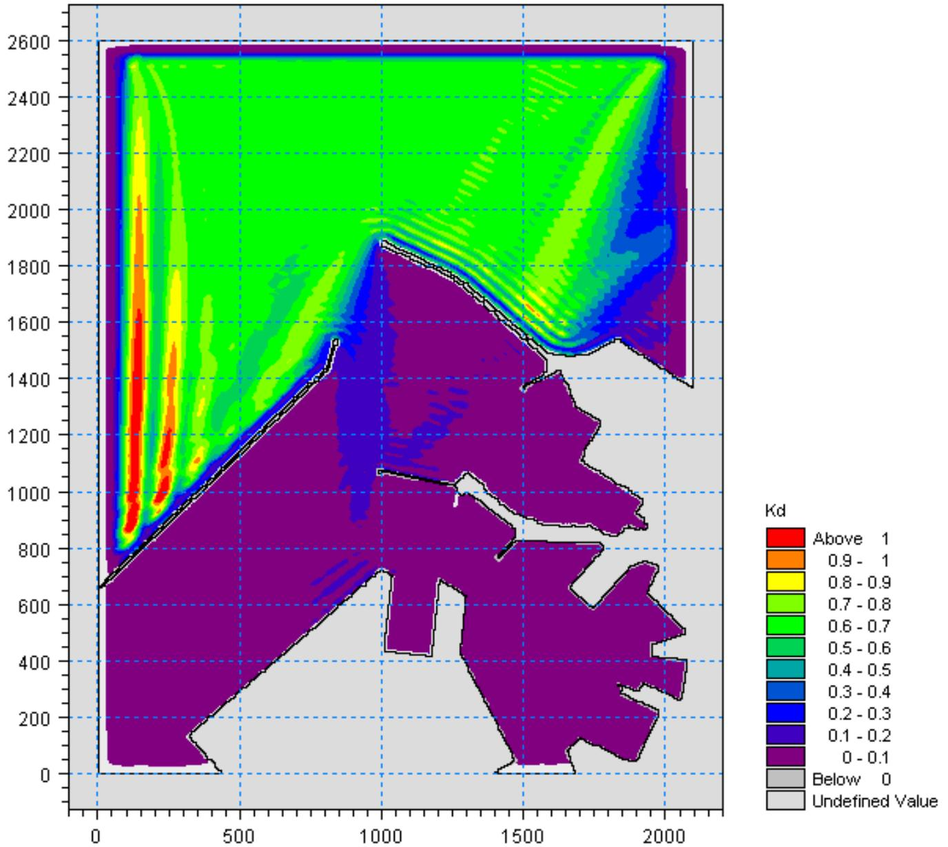
Figura 5.6 – Valori del coefficiente di diffrazione per l'attacco ondoso proveniente da  $0^{\circ}N$  con periodo  $T_p=7.5s$  nella zona portuale di Ancona per la configurazione attuale del Molo Nord
