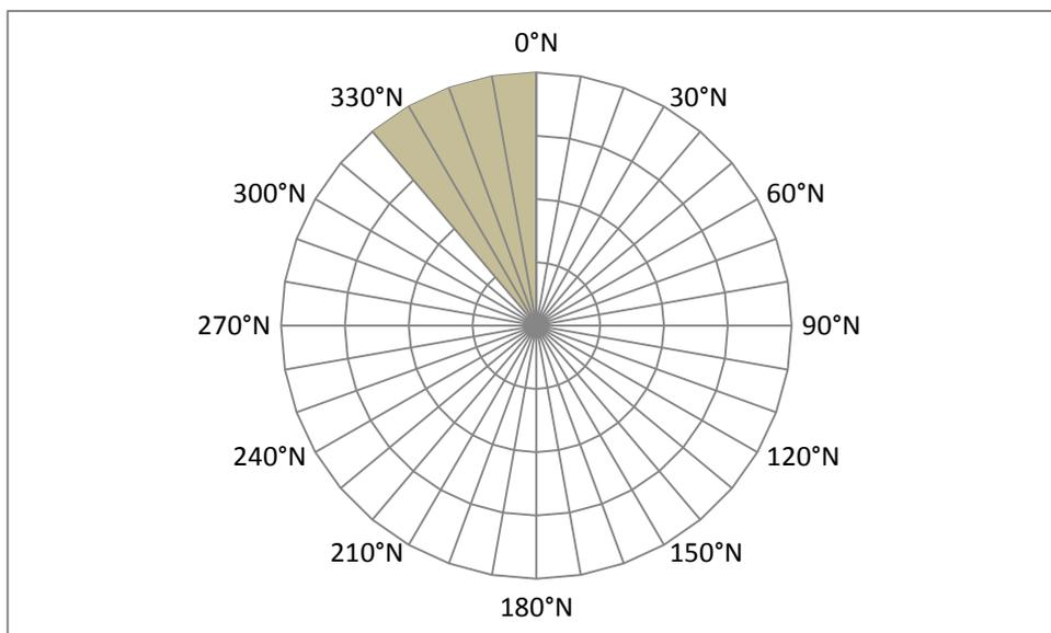
Figura 5.23 – Schema con le direzioni ondose di provenienza considerate (330°N - 0°N) per il periodo di picco  $T_P=30s$
