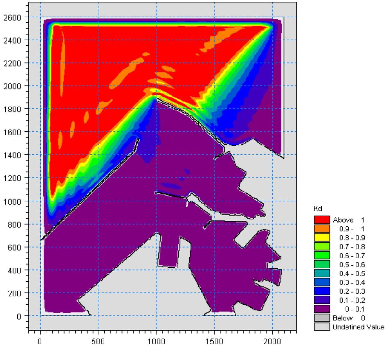
Figura 5.21 – Valori del coefficiente di diffrazione per l'attacco ondoso proveniente da  $20^\circ N$  con periodo  $T_P=12s$  nella zona portuale di Ancona per la configurazione attuale del Molo Nord
