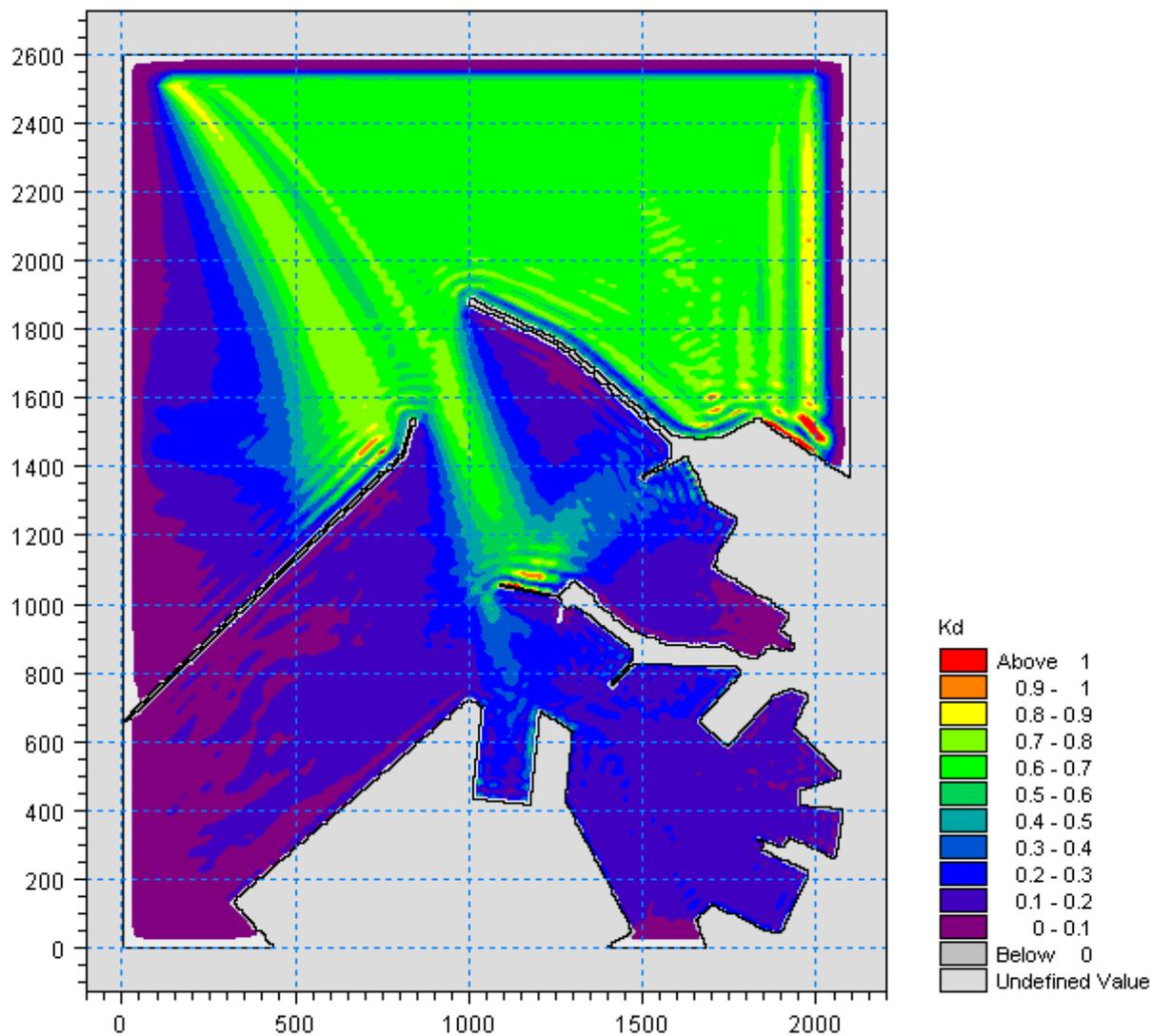
Figura 5.27 – Valori del coefficiente di diffrazione per l'attacco ondoso proveniente da  $320^\circ N$  con periodo  $T_p=7.5s$  nella zona portuale di Ancona per la configurazione con parziale demolizione (100m) del Molo Nord
