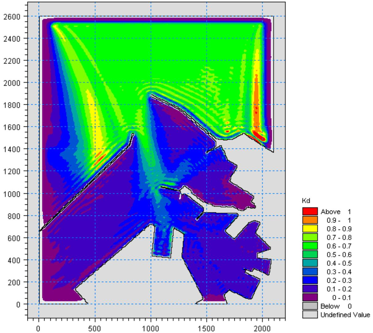
Figura 5.28 – Valori del coefficiente di diffrazione per l'attacco ondoso proveniente da 330°N con periodo  $T_p=7.5s$  nella zona portuale di Ancona per la configurazione con parziale demolizione (100m) del Molo Nord
