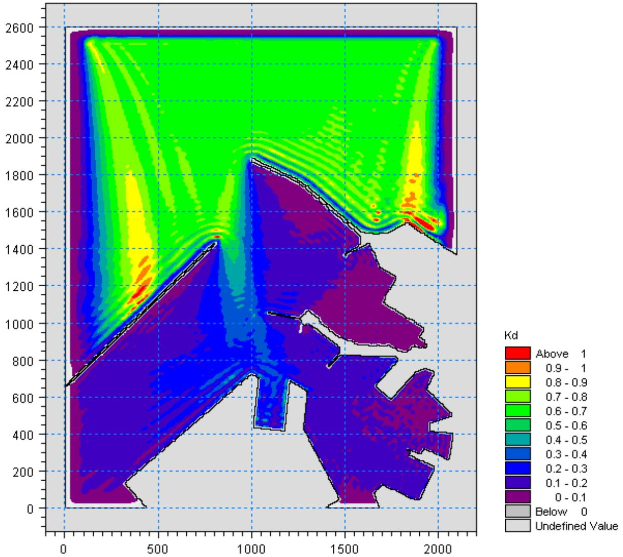
Figura 5.53 – Valori del coefficiente di diffrazione per l'attacco ondoso proveniente da 330°N con periodo  $T_p=7.5s$  nella zona portuale di Ancona per la configurazione con demolizione del Molo Nord (100m) e parziale realizzazione della diga di sottoflutto (assenza tratto terminale inclinato)
