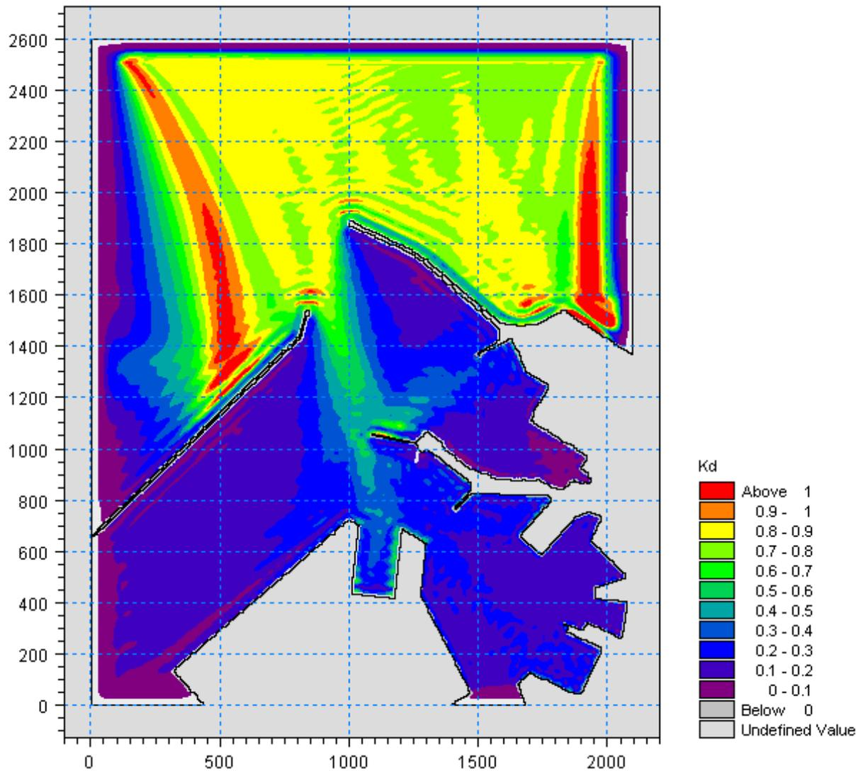
Figura 5.35 – Valori del coefficiente di diffrazione per l'attacco ondoso proveniente da 330°N con periodo  $T_p=9s$  nella zona portuale di Ancona per la configurazione con demolizione del Molo Nord (100m) e parziale realizzazione della diga di sottoflutto (assenza tratto terminale inclinato)
