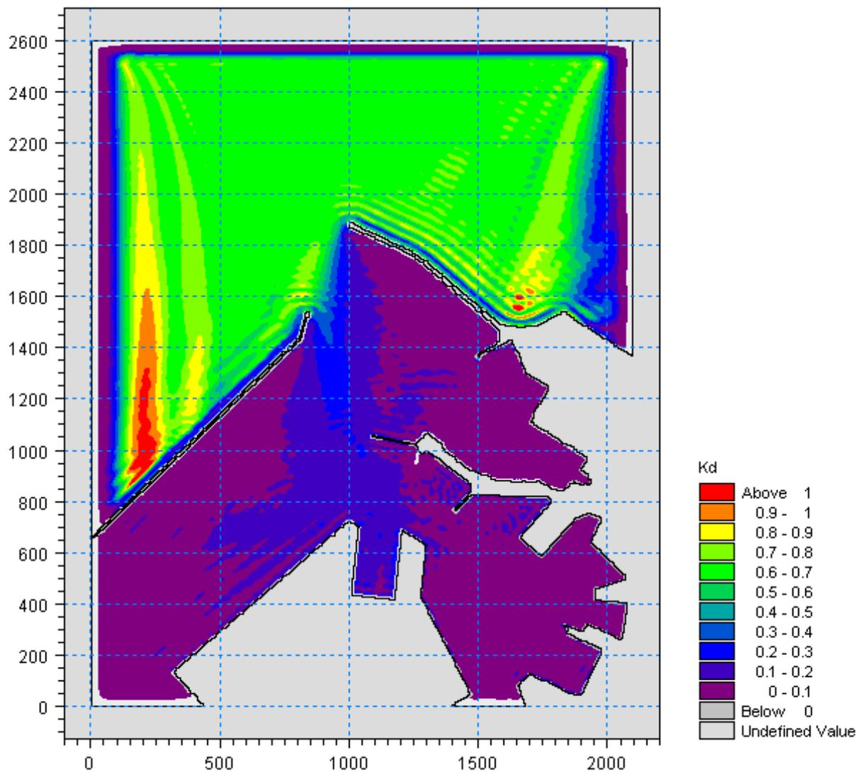
Figura 5.30 – Valori del coefficiente di diffrazione per l'attacco ondoso proveniente da 350°N con periodo  $T_p=7.5s$  nella zona portuale di Ancona per la configurazione con demolizione del Molo Nord (100m) e parziale realizzazione della diga di sottoflutto (assenza tratto terminale inclinato)
