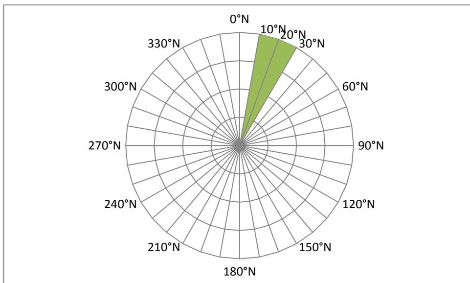
Figura 5.44 – Schema con le direzioni ondose di provenienza considerate ( $10^\circ N - 20^\circ N - 30^\circ N$ ) per il periodo di picco  $T_P=12s$
