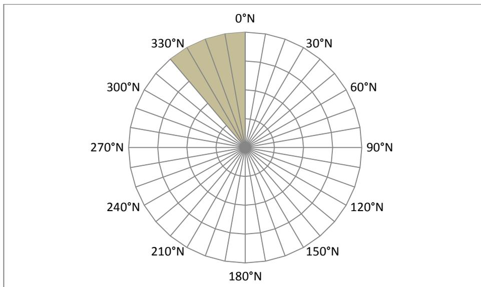
Figura 5.48 – Schema con le direzioni ondose di provenienza considerate (330°N - 0°N) per il periodo di picco  $T_P=30s$
