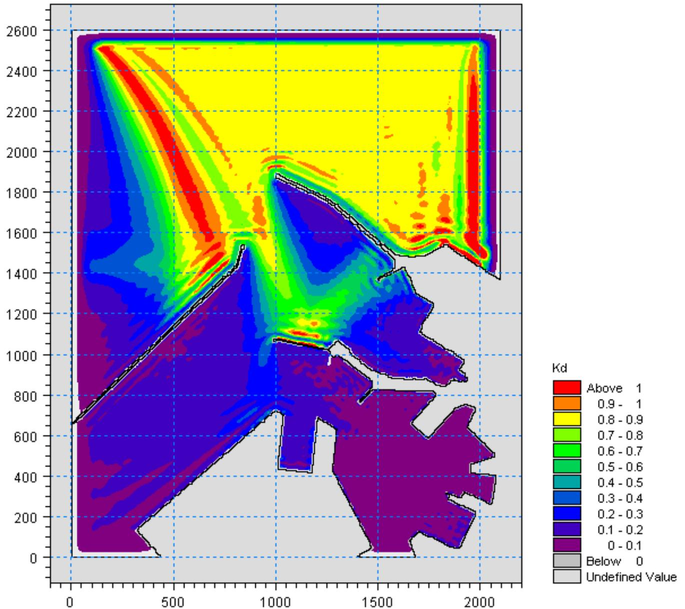
Figura 5.9 - Valori del coefficiente di diffrazione per l'attacco ondoso proveniente da  $320^\circ N$  con periodo  $T_p=9s$  nella zona portuale di Ancona per la configurazione attuale del Molo Nord
