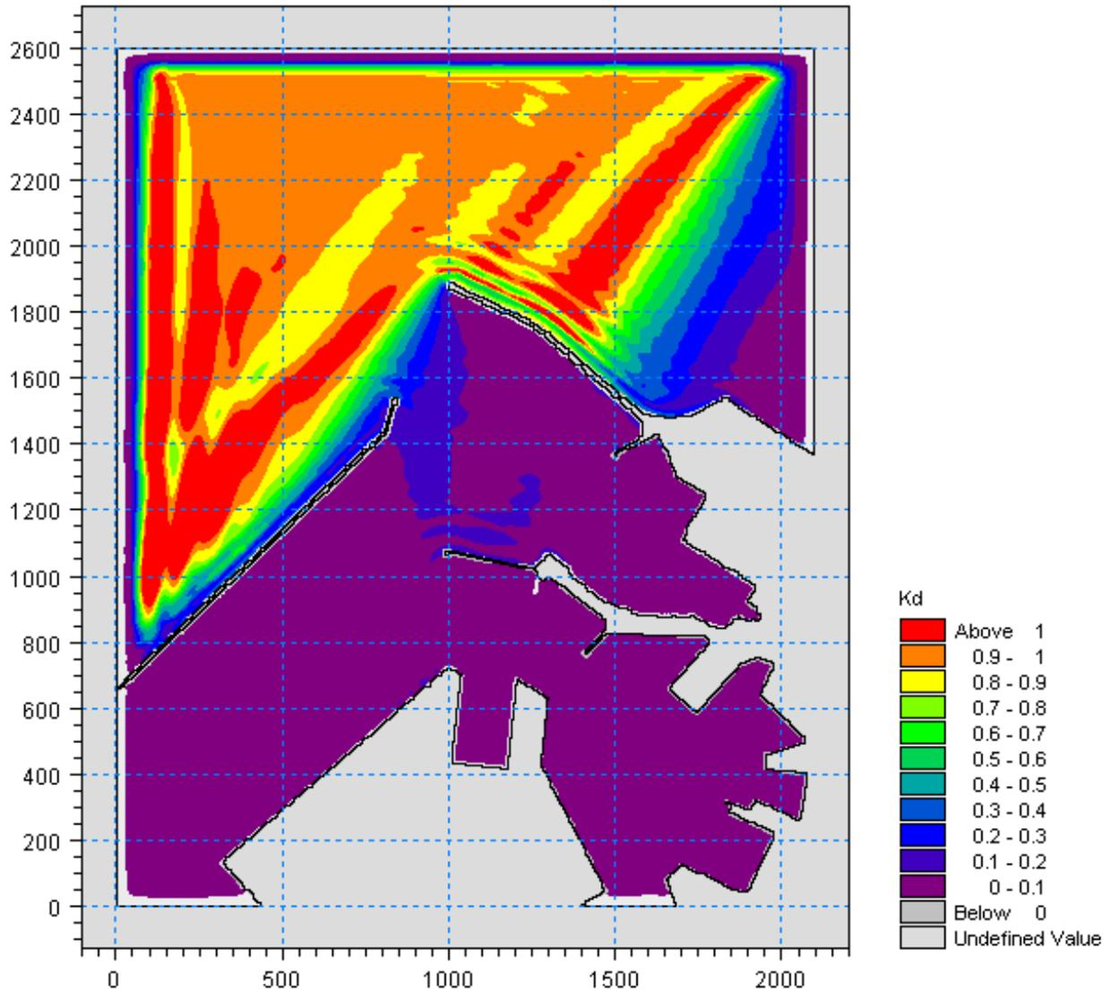
Figura 5.17 – Valori del coefficiente di diffrazione per l'attacco ondoso proveniente da  $10^\circ N$  con periodo  $T_P=10.5s$  nella zona portuale di Ancona per la configurazione attuale del Molo Nord
