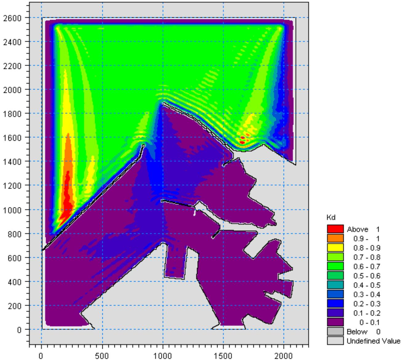
Figura 5.5 - Valori del coefficiente di diffrazione per l'attacco ondoso proveniente da  $350^\circ N$  con periodo  $T_p=7.5s$  nella zona portuale di Ancona per la configurazione attuale del Molo Nord
