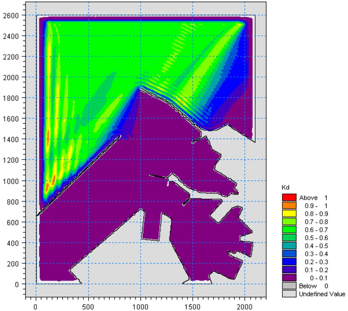
Figura 5.57 – Valori del coefficiente di diffrazione per l'attacco ondoso proveniente da  $10^{\circ}N$  con periodo  $T_p=7.5s$  nella zona portuale di Ancona per la configurazione con demolizione del Molo Nord (100m) e parziale realizzazione della diga di sottoflutto (assenza tratto terminale inclinato)
