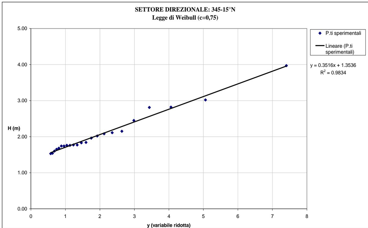
*Figura 3.19 - Dati sperimentali e legge probabilistica di miglior adattamento per il settore direzionale 345°N-15°N.*
