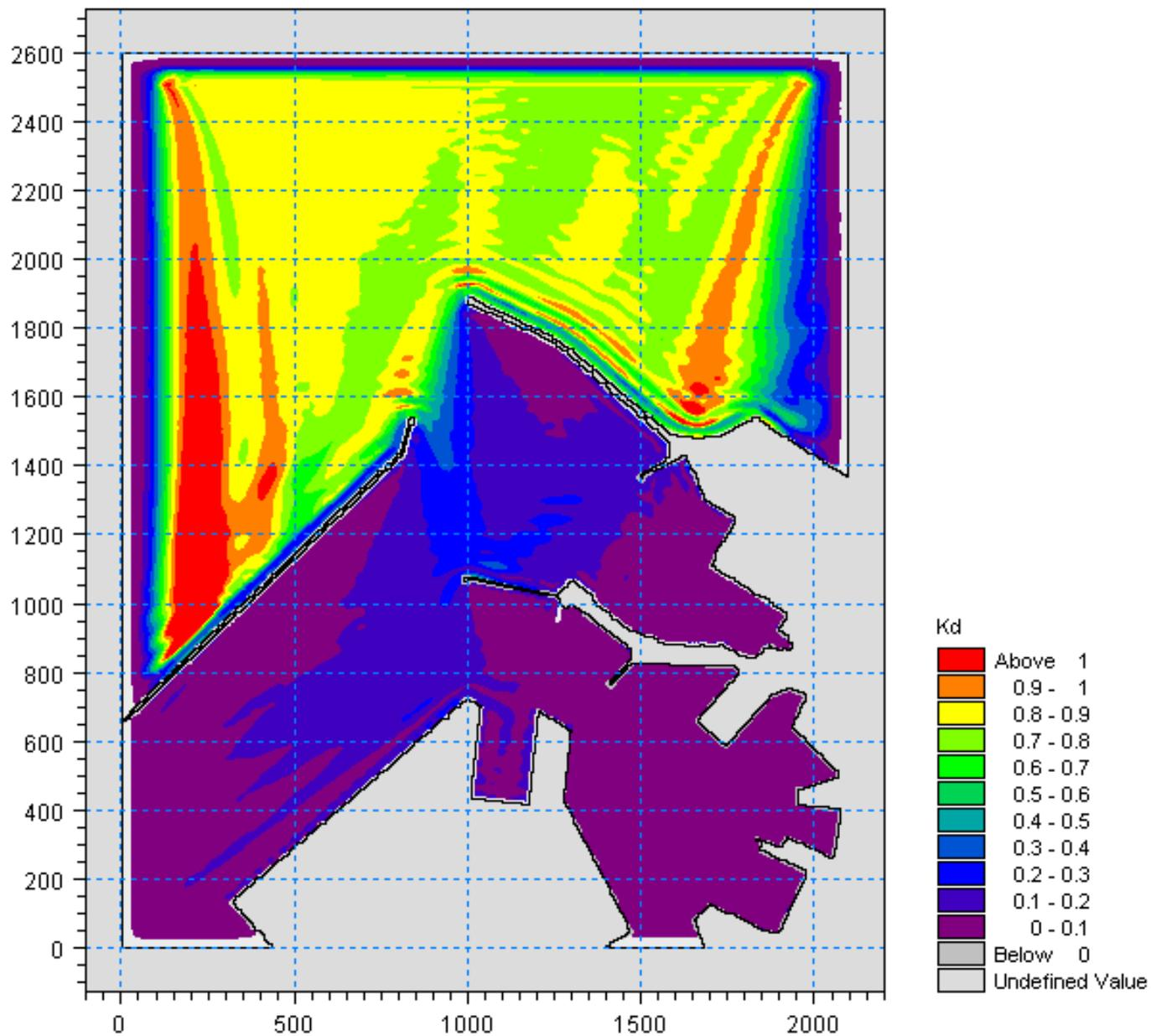
Figura 5.12 – Valori del coefficiente di diffrazione per l'attacco ondoso proveniente da  $350^\circ N$  con periodo  $T_p=9s$  nella zona portuale di Ancona per la configurazione attuale del Molo Nord
