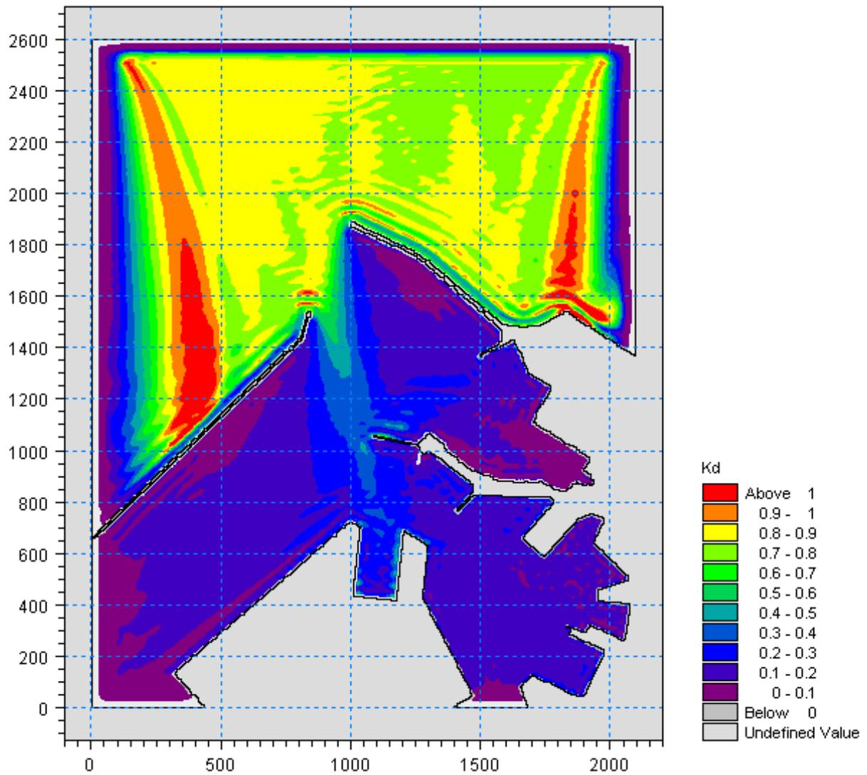
Figura 5.36 – Valori del coefficiente di diffrazione per l'attacco ondoso proveniente da 340°N con periodo  $T_p=9s$  nella zona portuale di Ancona per la configurazione con demolizione del Molo Nord (100m) e parziale realizzazione della diga di sottoflutto (assenza tratto terminale inclinato)
