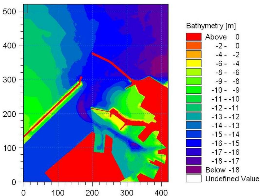
Figura 4.6 – Configurazione morfologica dei fondali adattato utilizzata per le simulazioni dell'analisi dell'agitazione ondosa interna al Porto di Ancona, per la configurazione attuale del Molo Nord, con il modello MIKE 21 BW.
