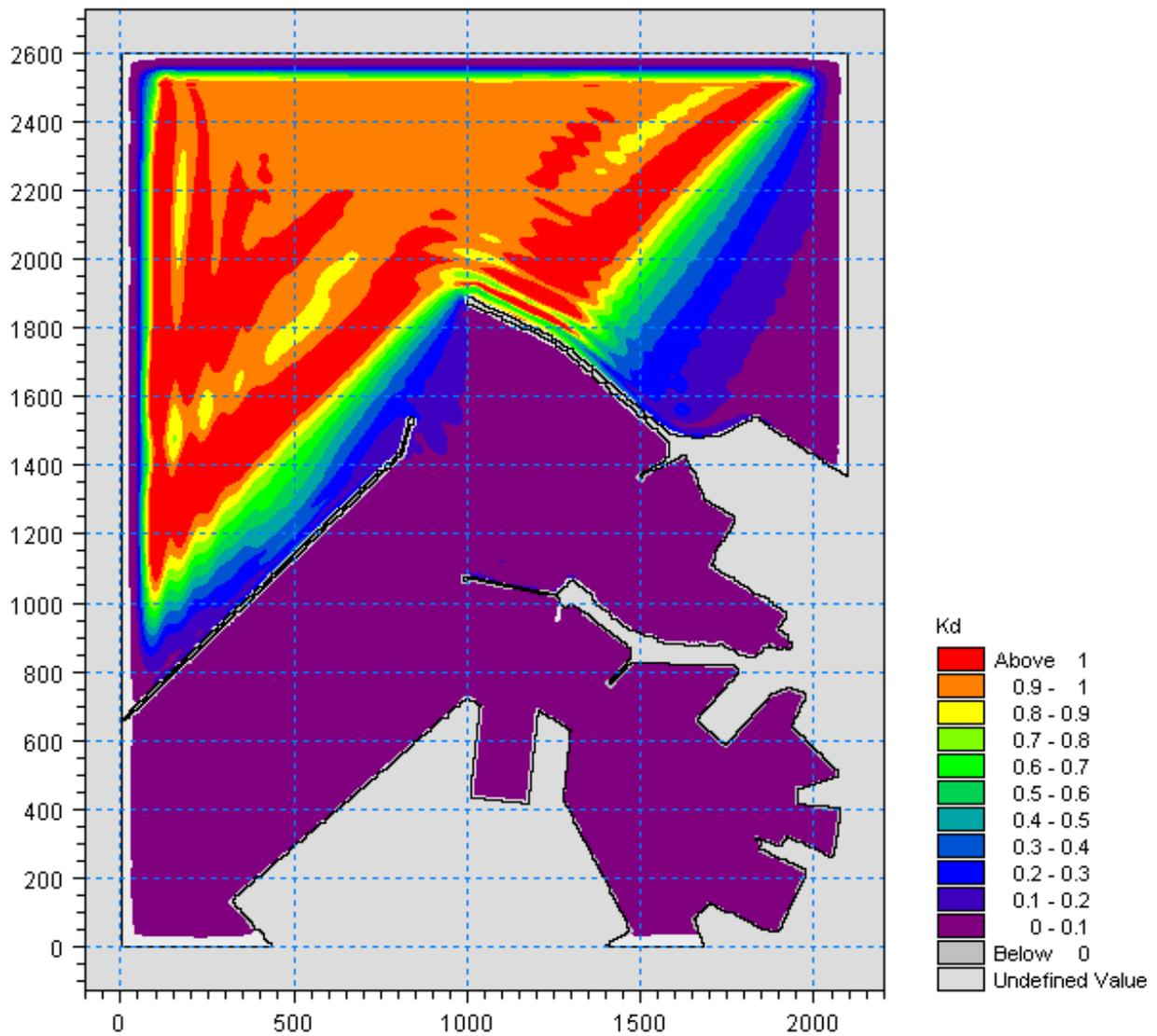
Figura 5.18 – Valori del coefficiente di diffrazione per l'attacco ondoso proveniente da 20°N con periodo  $T_p=10.5s$  nella zona portuale di Ancona per la configurazione attuale del Molo Nord
