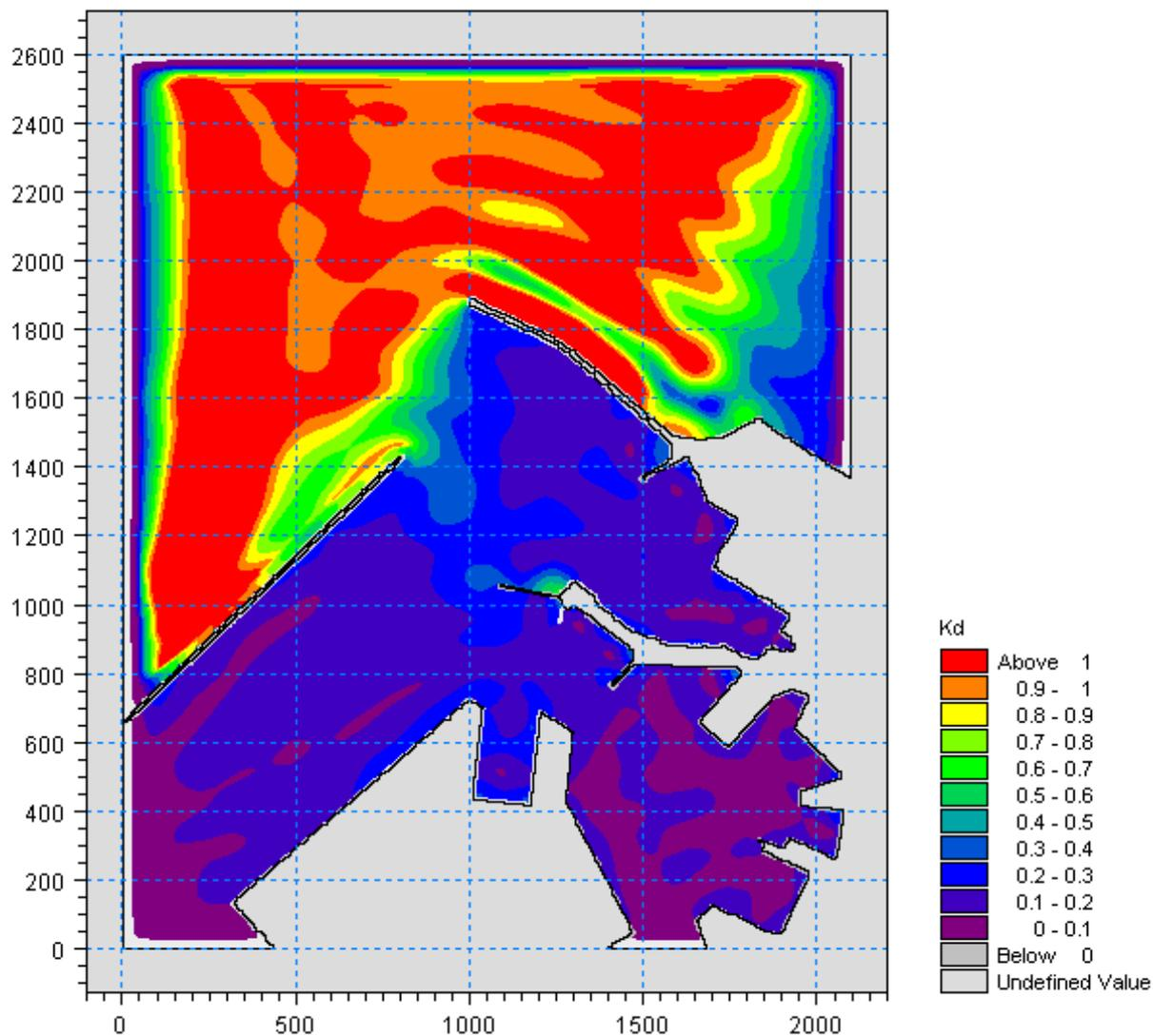
Figura 5.75 – Valori del coefficiente di diffrazione per l'attacco ondoso proveniente da  $0^\circ N$  con periodo  $T_p=30s$  nella zona portuale di Ancona per la configurazione con demolizione del Molo Nord (100m) e parziale realizzazione della diga di sottoflutto (assenza tratto terminale inclinato)
