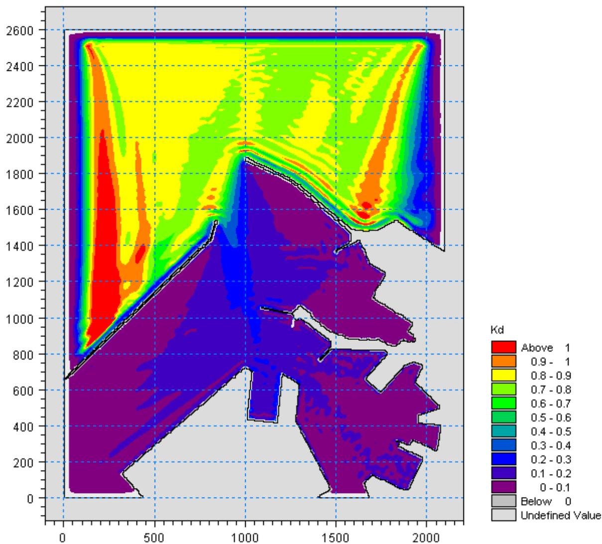
Figura 5.37 – Valori del coefficiente di diffrazione per l'attacco ondoso proveniente da  $350^\circ\text{N}$  con periodo  $T_p=9\text{s}$  nella zona portuale di Ancona per la configurazione con demolizione del Molo Nord (100m) e parziale realizzazione della diga di sottoflutto (assenza tratto terminale inclinato)
