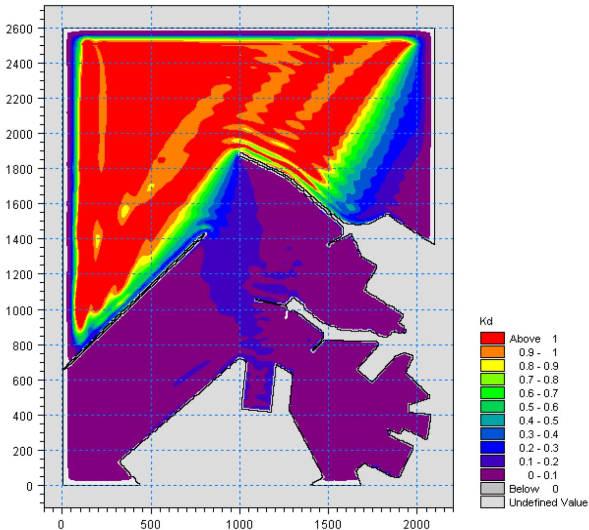
Figura 5.70 – Valori del coefficiente di diffrazione per l'attacco ondoso proveniente da  $10^\circ N$  con periodo  $T_p=12s$  nella zona portuale di Ancona per la configurazione con demolizione del Molo Nord (100m) e parziale realizzazione della diga di sottoflutto (assenza tratto terminale inclinato)
