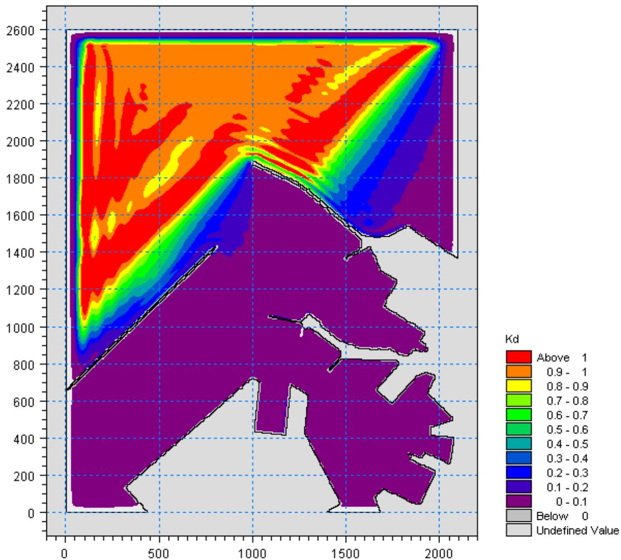
Figura 5.68 – Valori del coefficiente di diffrazione per l'attacco ondoso proveniente da  $20^{\circ}N$  con periodo  $T_p=10.5s$  nella zona portuale di Ancona per la configurazione con demolizione del Molo Nord (100m) e parziale realizzazione della diga di sottoflutto (assenza tratto terminale inclinato)
