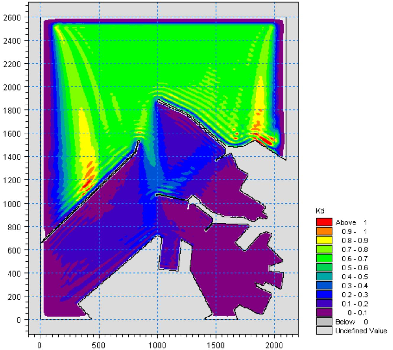
Figura 5.4 - Valori del coefficiente di diffrazione per l'attacco ondoso proveniente da  $340^\circ N$  con periodo  $T_p=7.5s$  nella zona portuale di Ancona per la configurazione attuale del Molo Nord
