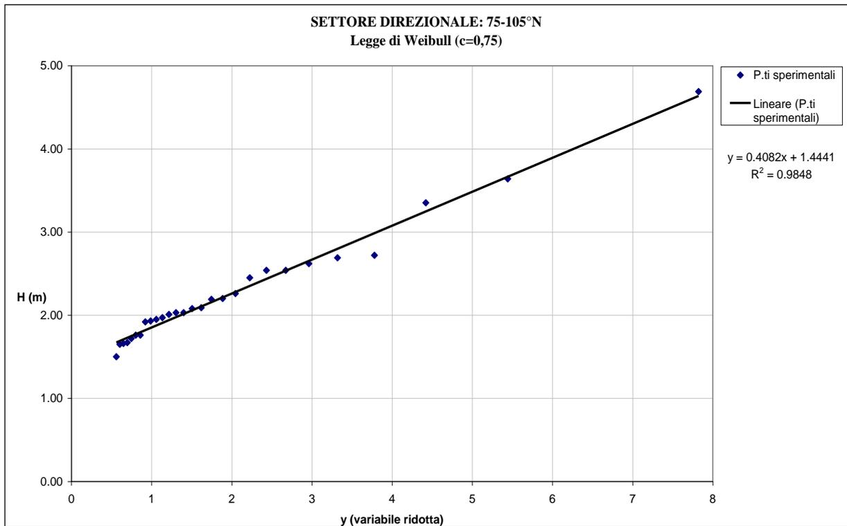
*Figura 3.15 - Dati sperimentali e legge probabilistica di miglior adattamento per il settore direzionale 75°N-105°N.*
