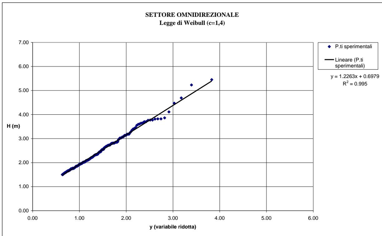
*Figura 3.20 - Dati sperimentali e legge probabilistica di miglior adattamento per il settore omnidirezionale.*
