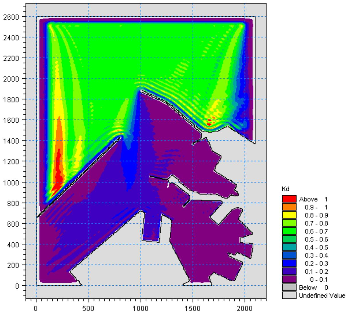
Figura 5.55 – Valori del coefficiente di diffrazione per l'attacco ondoso proveniente da  $350^{\circ}N$  con periodo  $T_p=7.5s$  nella zona portuale di Ancona per la configurazione con demolizione del Molo Nord (100m) e parziale realizzazione della diga di sottoflutto (assenza tratto terminale inclinato)
