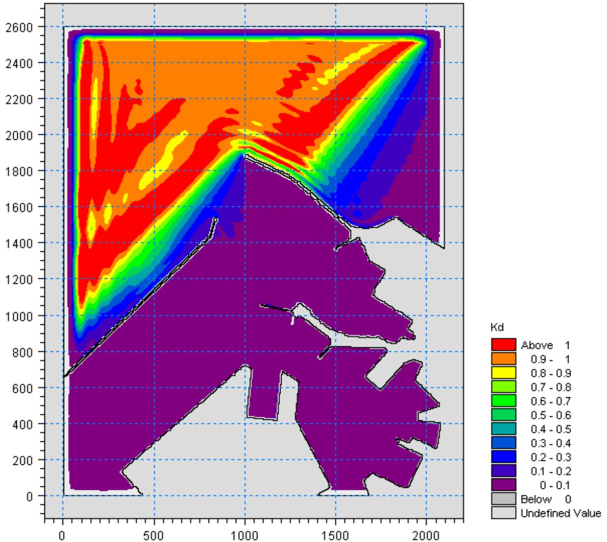
Figura 5.43 – Valori del coefficiente di diffrazione per l'attacco ondoso proveniente da 20°N con periodo  $T_p=10.5s$  nella zona portuale di Ancona per la configurazione con demolizione del Molo Nord (100m) e parziale realizzazione della diga di sottoflutto (assenza tratto terminale inclinato)
