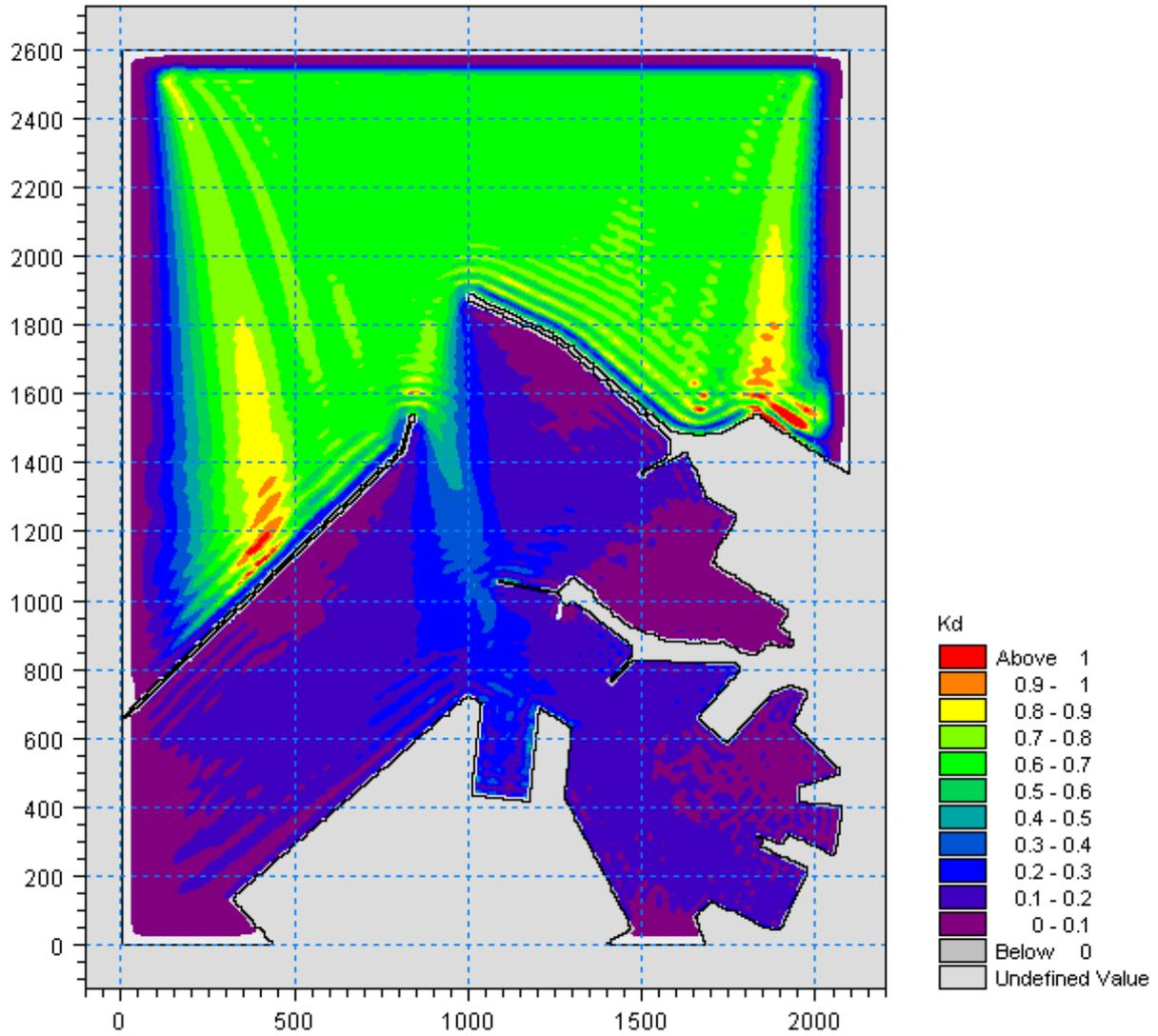
Figura 5.54 – Valori del coefficiente di diffrazione per l'attacco ondoso proveniente da 340°N con periodo  $T_p=7.5s$  nella zona portuale di Ancona per la configurazione con demolizione del Molo Nord (100m) e parziale realizzazione della diga di sottoflutto (assenza tratto terminale inclinato)
