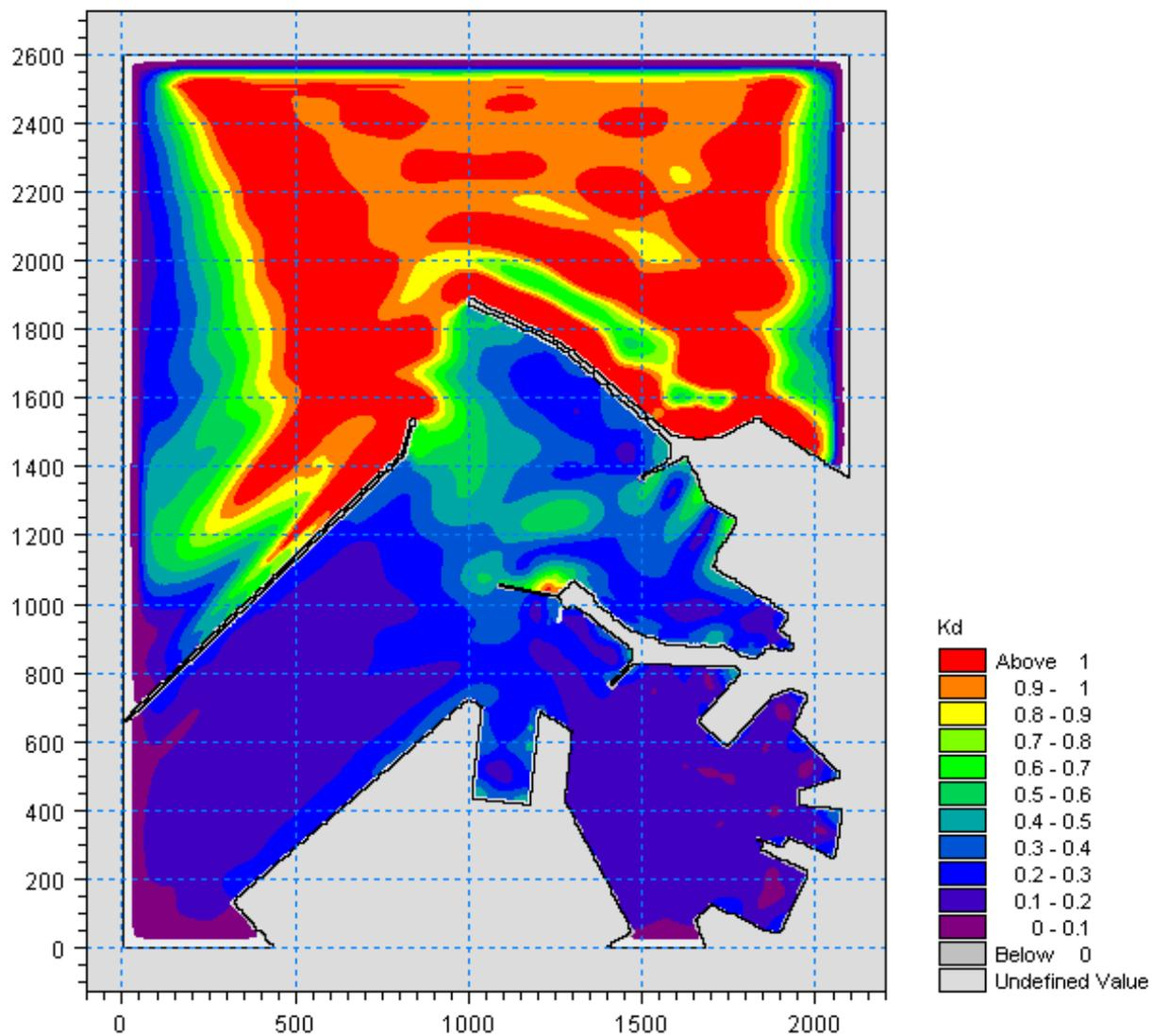
Figura 5.49 – Valori del coefficiente di diffrazione per l'attacco ondoso proveniente da  $330^\circ\text{N}$  con periodo  $T_p=30\text{s}$  nella zona portuale di Ancona per la configurazione con parziale demolizione (100m) del Molo Nord
