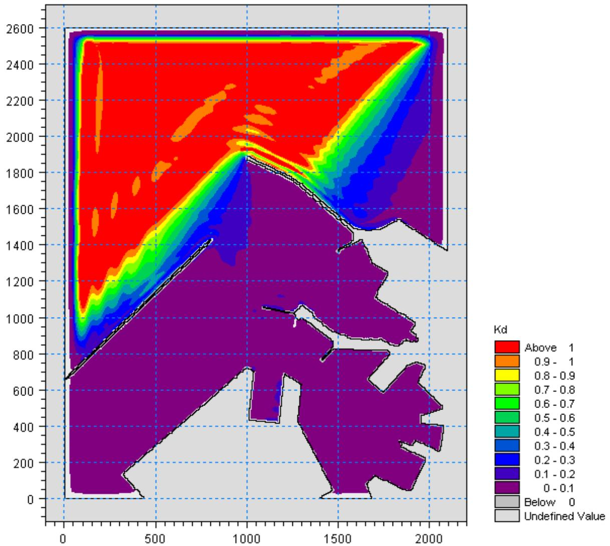
Figura 5.71 – Valori del coefficiente di diffrazione per l'attacco ondoso proveniente da 20°N con periodo  $T_p=12s$  nella zona portuale di Ancona per la configurazione con demolizione del Molo Nord (100m) e parziale realizzazione della diga di sottoflutto (assenza tratto terminale inclinato)
