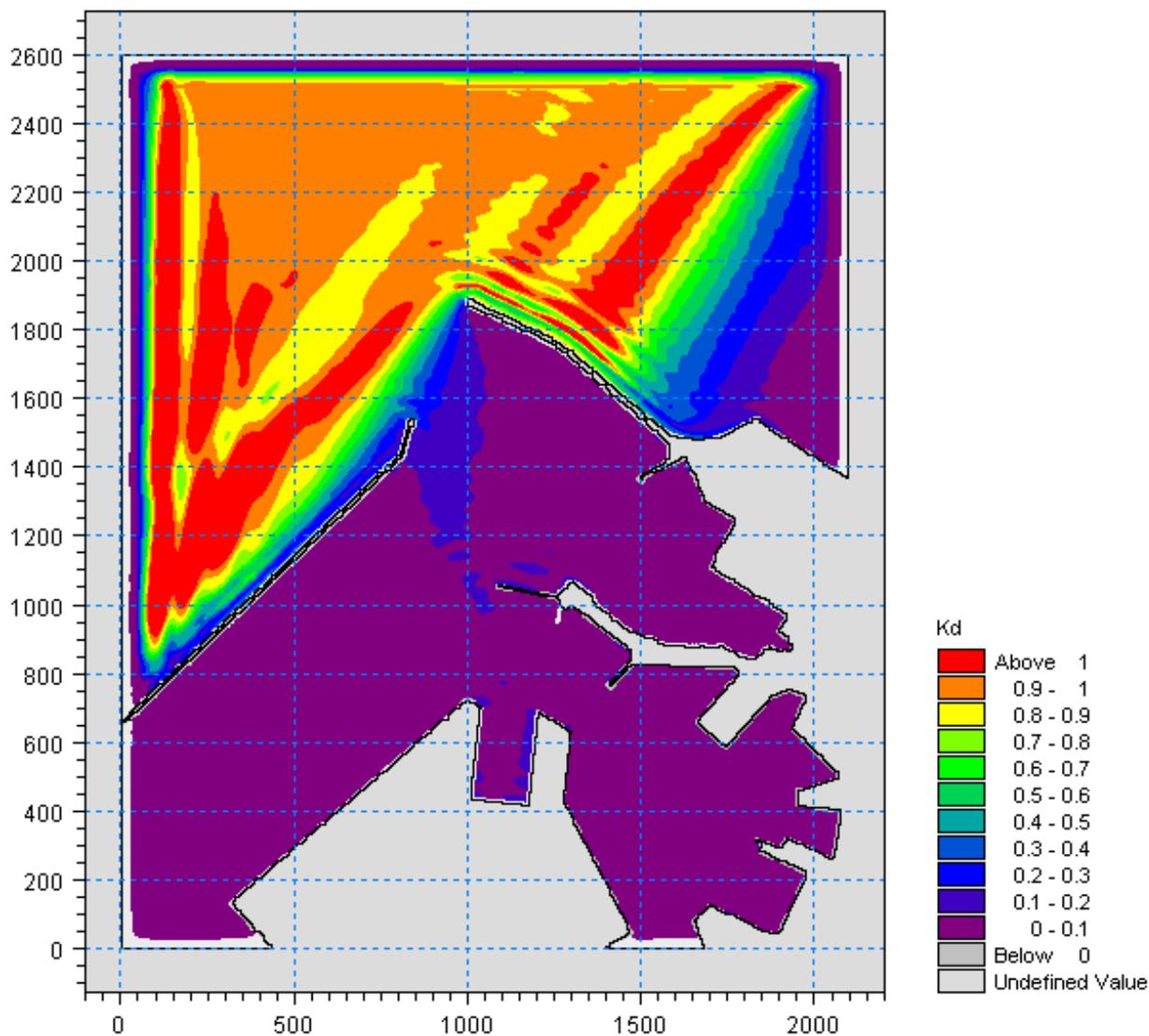
Figura 5.42 – Valori del coefficiente di diffrazione per l'attacco ondoso proveniente da  $10^\circ N$  con periodo  $T_p=10.5s$  nella zona portuale di Ancona per la configurazione con demolizione del Molo Nord (100m) e parziale realizzazione della diga di sottoflutto (assenza tratto terminale inclinato)
