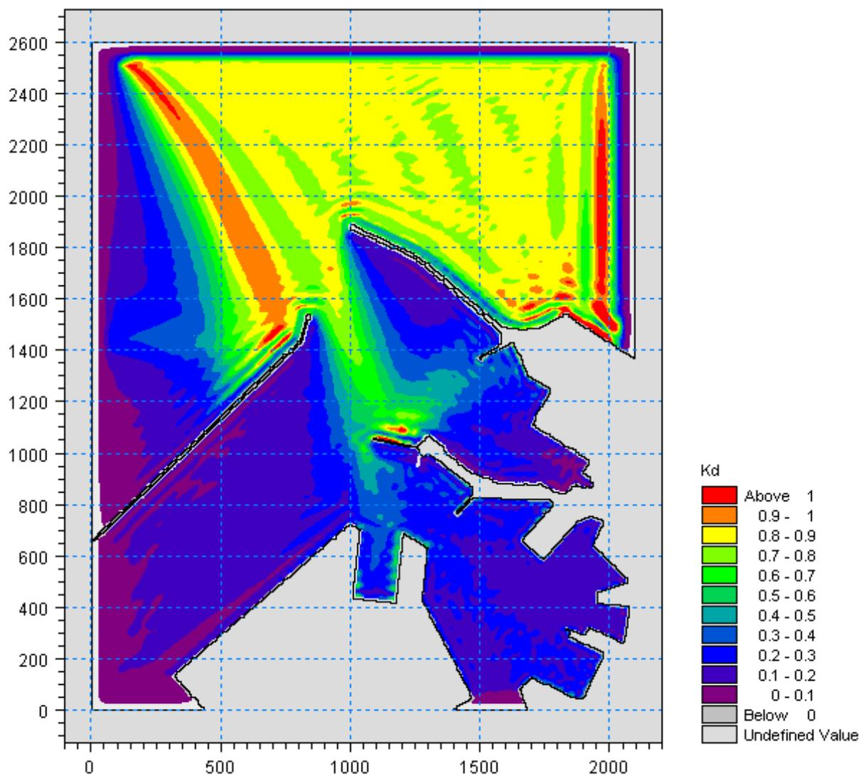
Figura 5.34 – Valori del coefficiente di diffrazione per l'attacco ondoso proveniente da  $320^\circ N$  con periodo  $T_p=9s$  nella zona portuale di Ancona per la configurazione con demolizione del Molo Nord (100m) e parziale realizzazione della diga di sottoflutto (assenza tratto terminale inclinato)
