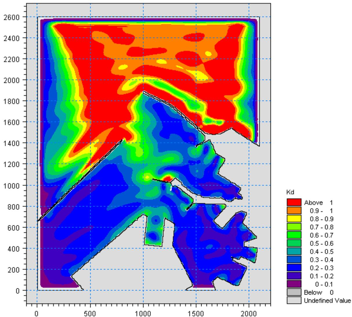
Figura 5.74 – Valori del coefficiente di diffrazione per l'attacco ondoso proveniente da 330°N con periodo  $T_p=30s$  nella zona portuale di Ancona per la configurazione con demolizione del Molo Nord (100m) e parziale realizzazione della diga di sottoflutto (assenza tratto terminale inclinato)
