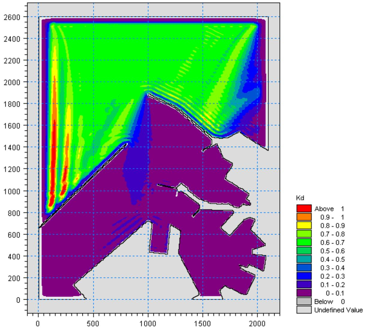
Figura 5.56 – Valori del coefficiente di diffrazione per l'attacco ondoso proveniente da 0°N con periodo  $T_p=7.5s$  nella zona portuale di Ancona per la configurazione con demolizione del Molo Nord (100m) e parziale realizzazione della diga di sottoflutto (assenza tratto terminale inclinato)
