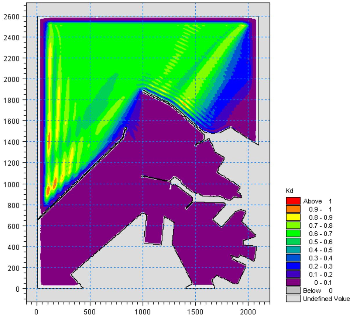
Figura 5.7 – Valori del coefficiente di diffrazione per l'attacco ondoso proveniente da  $10^{\circ}N$  con periodo  $T_p=7.5s$  nella zona portuale di Ancona per la configurazione attuale del Molo Nord
