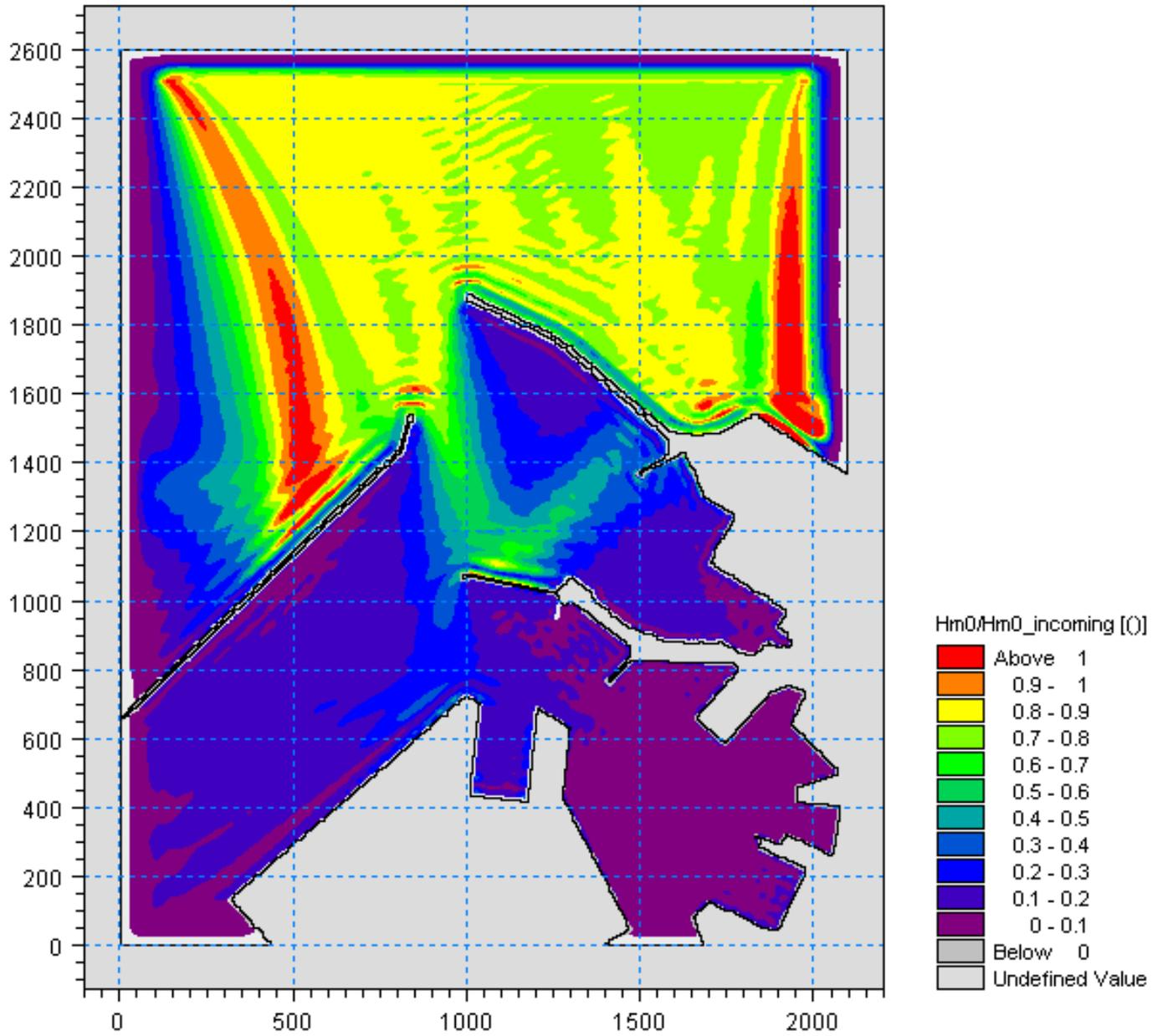
Figura 5.10 – Valori del coefficiente di diffrazione per l'attacco ondoso proveniente da 330°N con periodo  $T_p=9s$  nella zona portuale di Ancona per la configurazione attuale del Molo Nord
