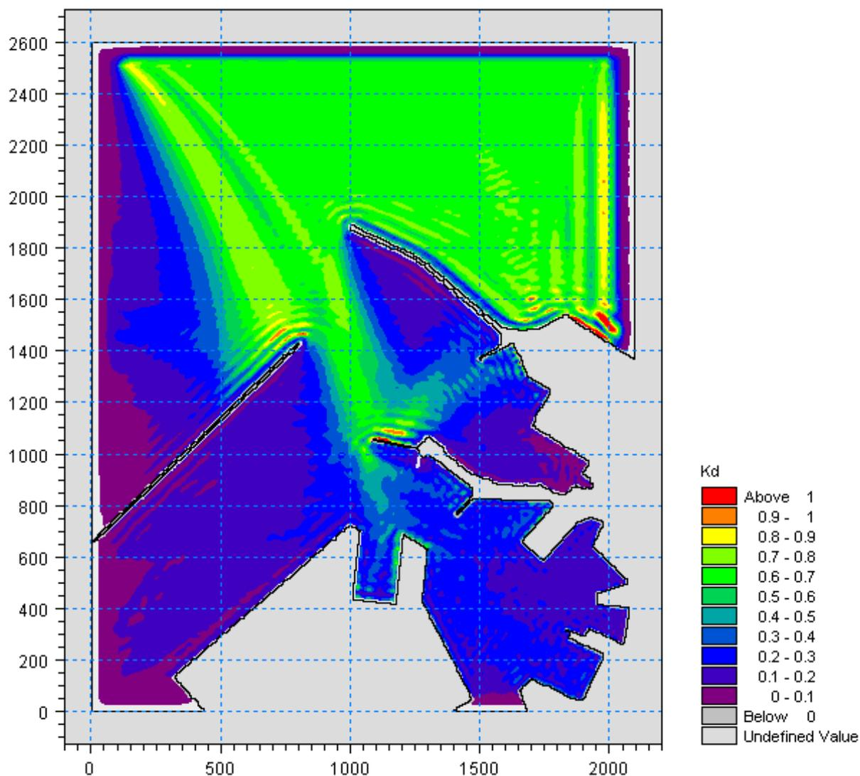
Figura 5.52 – Valori del coefficiente di diffrazione per l'attacco ondoso proveniente da 320°N con periodo  $T_p=7.5s$  nella zona portuale di Ancona per la configurazione con demolizione del Molo Nord (100m) e parziale realizzazione della diga di sottoflutto (assenza tratto terminale inclinato)
