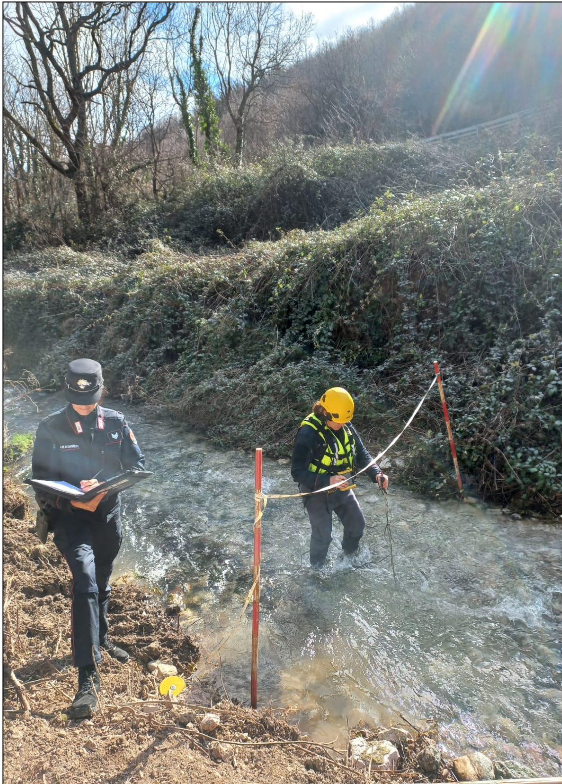
Carabinieri forestali in attività di controllo tecnico del D.M.V. su un corso d'acqua.
