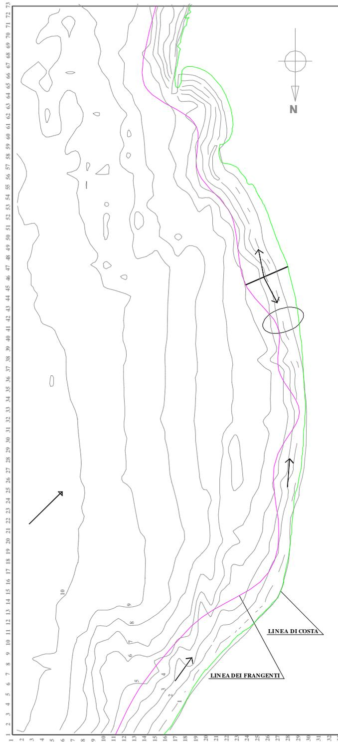
*Figura 2.6 – Reticolo locale: rappresentazione delle linee di frangimento. Direzione della corrente longshore e delle zone di convergenza.*
