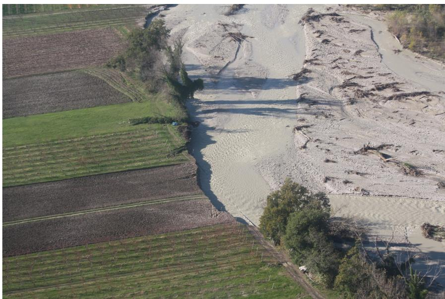
**Figura 44:** Erosione spondale con scalamo al piede del rilevato stradale SP104- Fiume Aso
