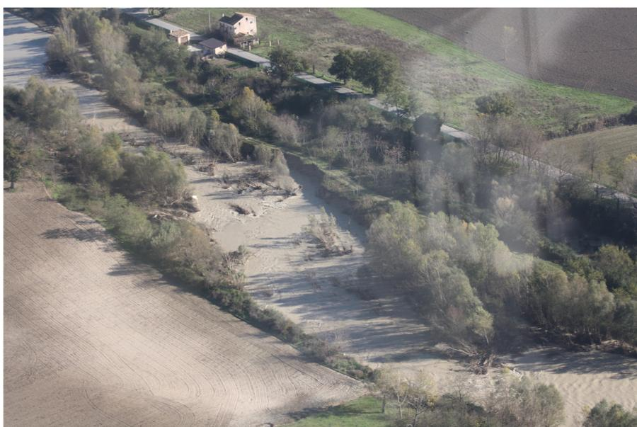
**Figura 58:** Erosioni spondali - fiume Potenza
