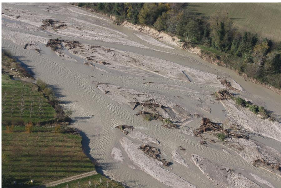
**Figura 42:** Erosione spondale - Fiume Aso
