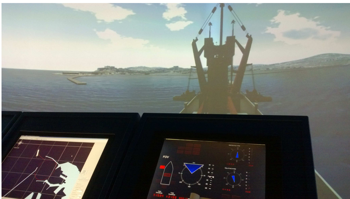
Figura 13 – Nave bulk in ingresso assistita da due rimorchiatori a spingere, visibili nello scenario 3D, e due rimorchiatori in posizione di tiro di poppa e di prora distinguibili in piccolo sul display 2D della plancia
