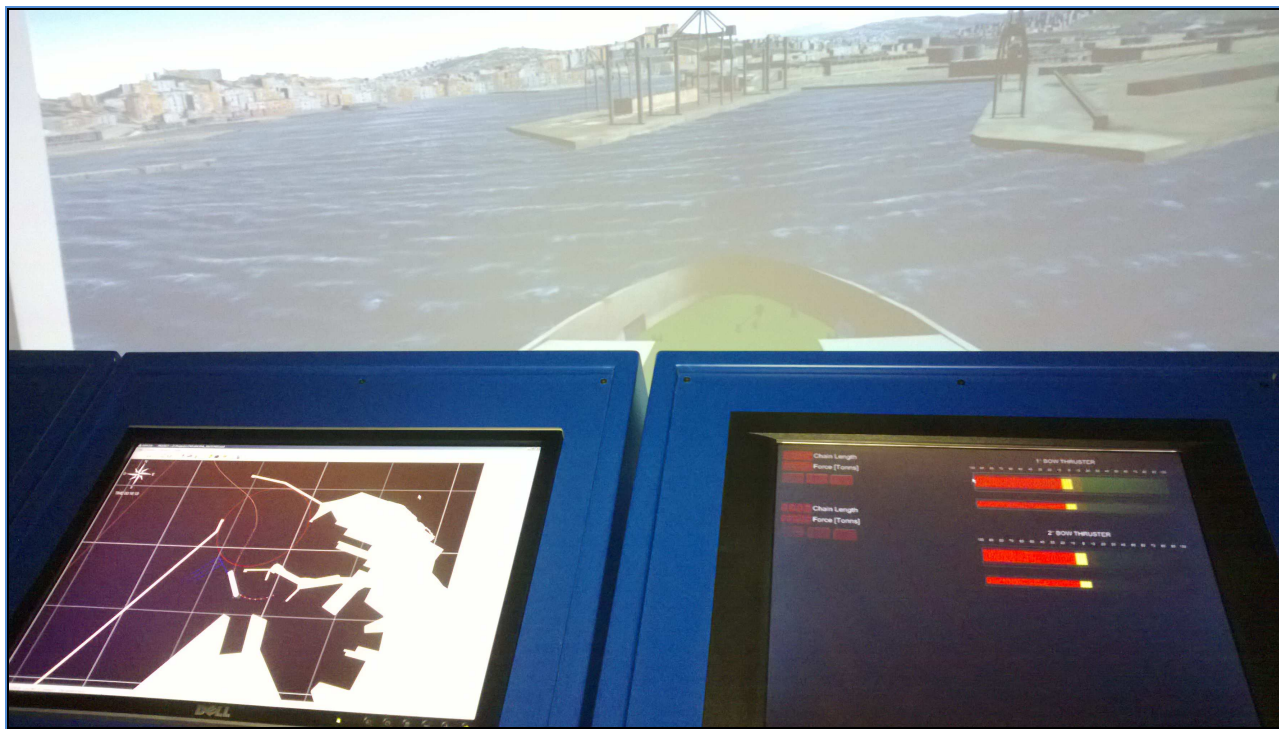
Fig. B- 14 Simulatore SAND. Ingresso della nave ro-pax vista dalla plancia, nel layout di molo N demolito. Si nota la maggiore sinuosità della traiettoria (in arancione, sullo schermo 2D della plancia), indicativa di una manovra più fluida rispetto al layout con molo integro. Si confronti a questo proposito la Fig. B- 4 commentata in precedenza.
