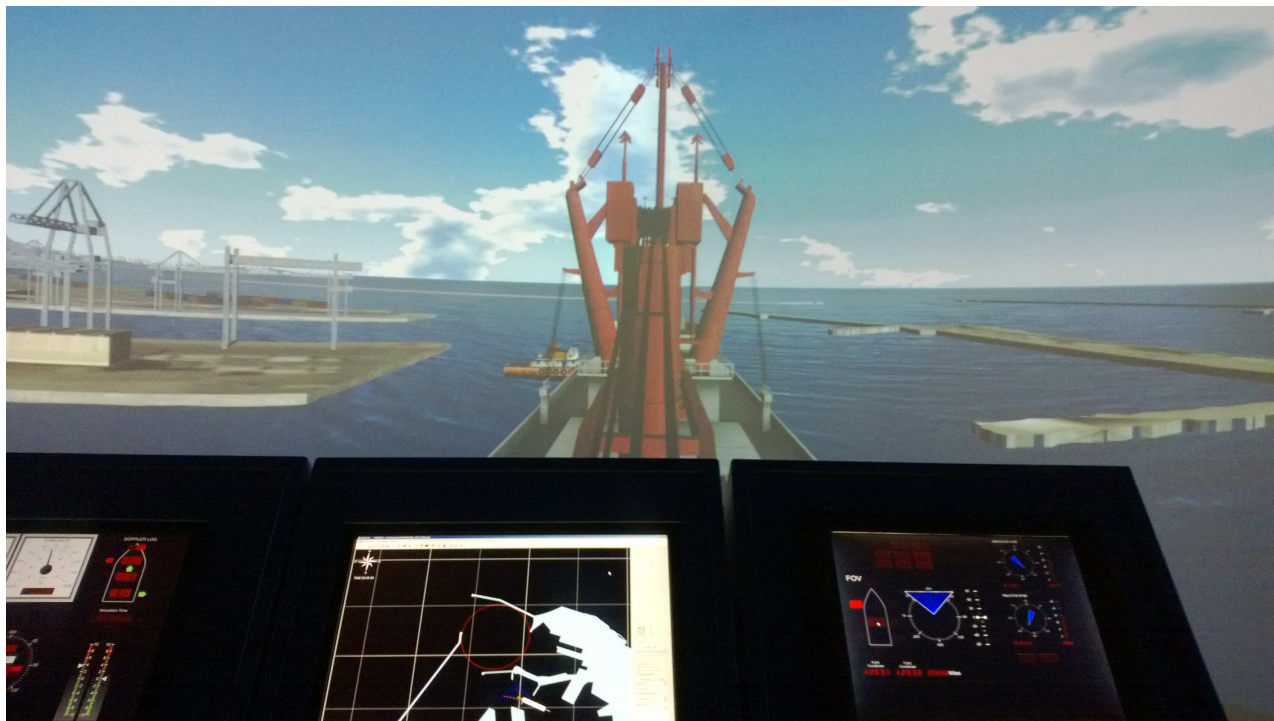
Figura 3 - Simulatore SAND – Schematizzazione dei rimorchiatori per la nave mercantile nello scenario 3D di Ancona (nella foto, l'uscita della nave dal Porto, con molo Nord non demolito, vista dall'aletta di sinistra)
