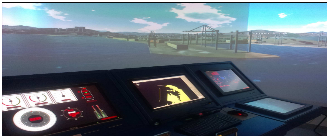
Figura 1 - Scenario 3D relativo al Porto di Ancona e plancia del simulatore SAND
