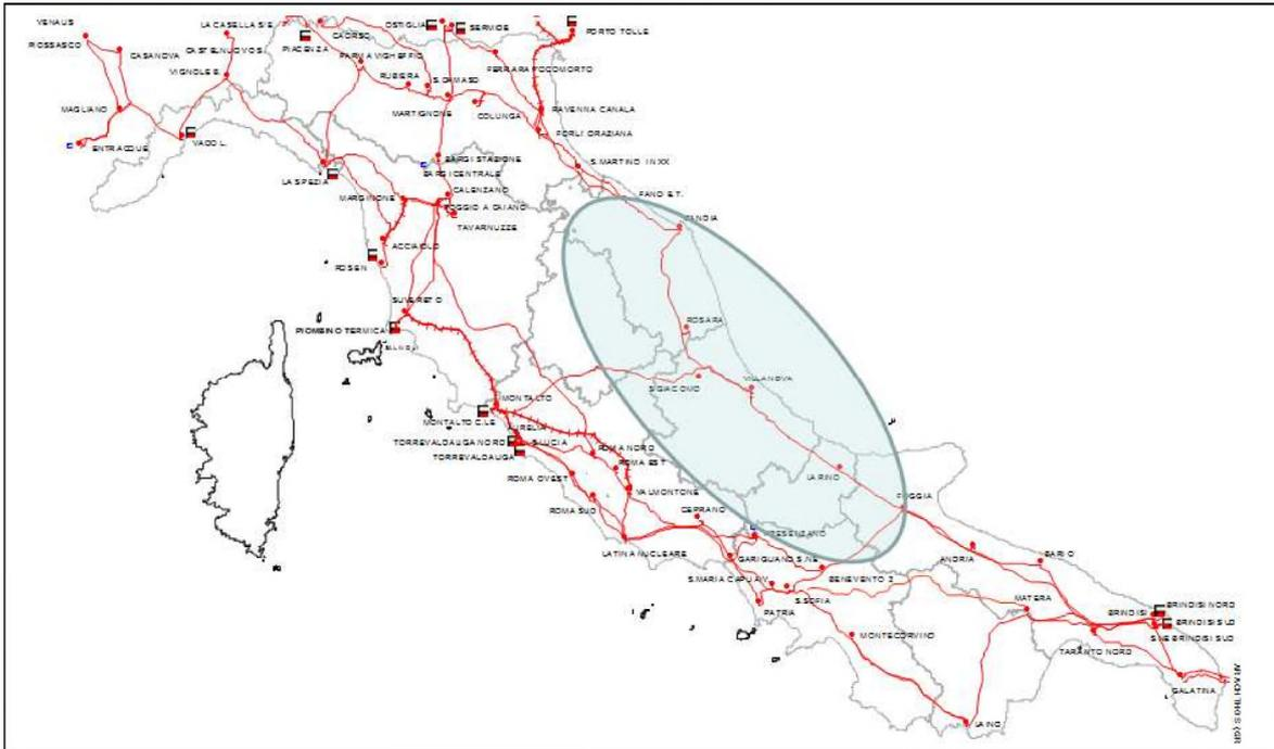
**Figura 3: magliatura della Rete di Trasmissione Nazionale a 380 kV nel Centro Italia**<sup>53</sup>
