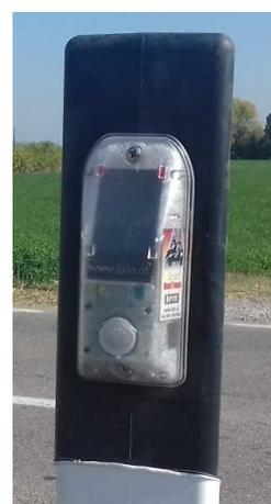
Figura 152 – Dissuasori elettronici di diverso modello (A e B) impiegati nell'ambito del progetto sperimentale in corso in Emilia- Romagna ([Sperimentazione Regione Emilia-Romagna](#)).
