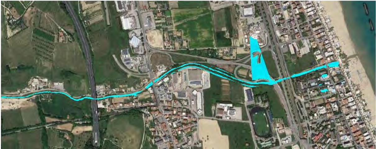
Figura 30 -Esempio delle aree di esondazione del tratto terminale del Torrente Ragnola per un Tr di 200 anni
