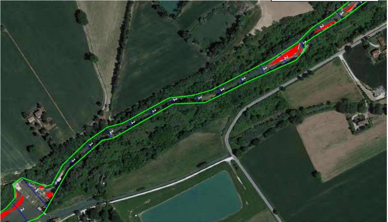
Figura 42 - Determinazione dell'Indice di intrecciamento (Ii) o di anastomizzazione (Ia) – (verde: limite dell'alveo pieno; rosso: barre o isole; blu: transetti per il calcolo del numero medio di canali separati  $(2+1+1+1+1+1+1+1+1+1+2+1+2+1+1)/18$ )
