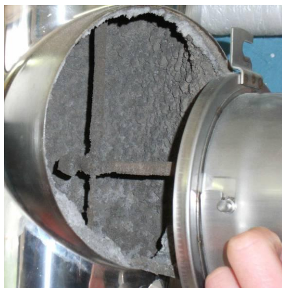
2. incrostazioni di fuliggine sull'elettrodo
