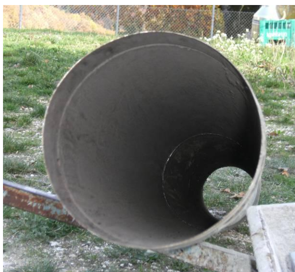
1. tubo pulito prima del montaggio del filtro
